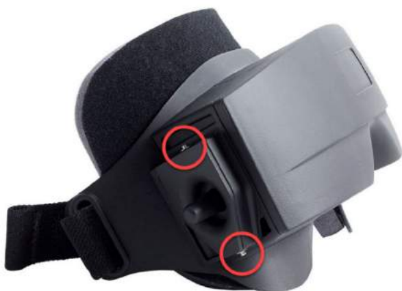
Рис. 2.6-3: Шестигранні фіксуючі гвинти у верхній і нижній частинах маски з боковими камерами, що використовуються для фіксації камери або кришки (на рисунку)
