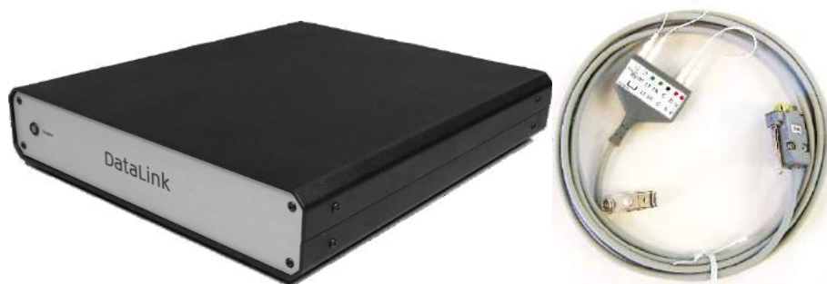
Рис. 2.6-38: DataLink та кабель пацієнта EOG
