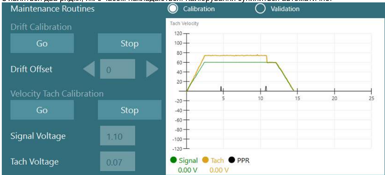
Рис. 2.6-37: Калібрування дрейфу та тахометра швидкості для оптичного барабана для крісел Авто-Траверс/Комплексне
