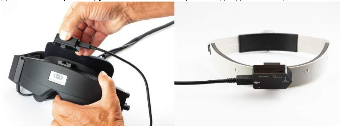
Рис. 2.6-17: Кріплення VORTEQ™ 2 ге покоління IMU на масці з бічними камерами (ліворуч) та зображення прикріпленого на оголів'я датчика для тесту Динамічної гостроти зору (праворуч)
