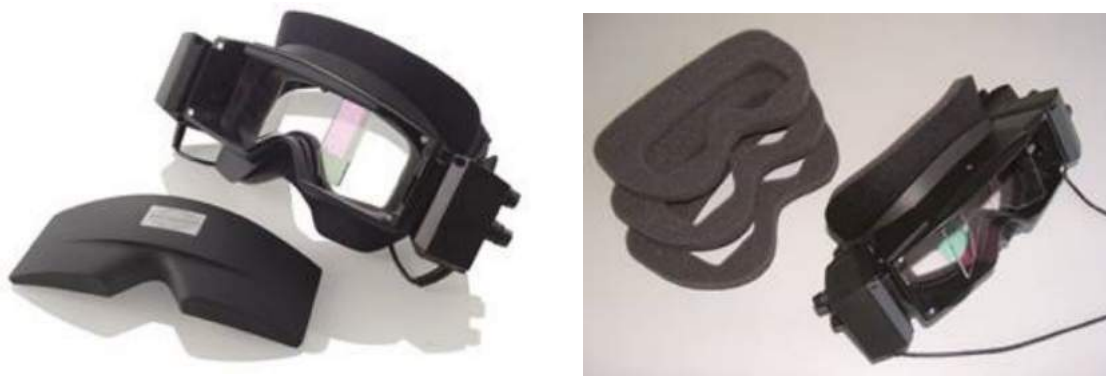
Рис. 2.6-2: Маска з боковими камерами із знімною кришкою (ліворуч) та знімні одноразові пінопластові прокладки (праворуч)
