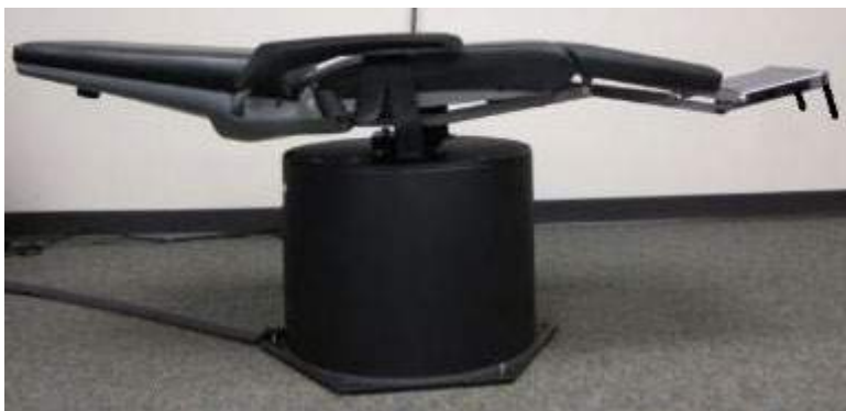
Рис. 3.9-1 Крісло із знятим підголовником в горизонтальному положенні для проведення теста Дікса-Холлпайка (Orion та System 2000)
