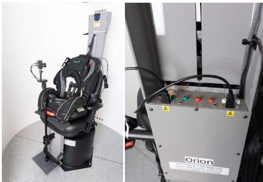
Рис. 2.6-30: Педіатрична камера спостереження, прикріплена до крісла Orion Авто-Траверс/Комплексне і підключена до USB-портів на спинці крісла
