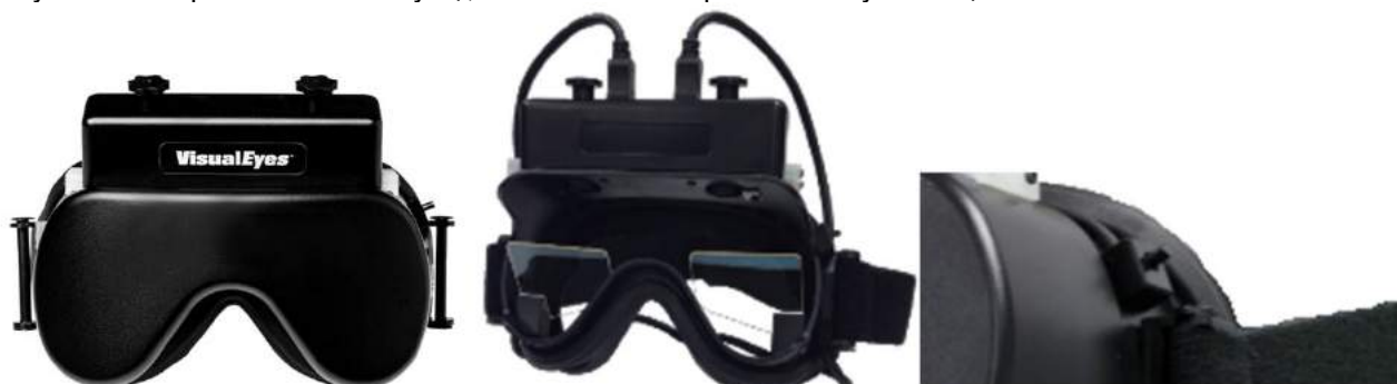
Рис. 2.6-5: Маска з верхніми камерами з кришкою (ліворуч), без кришки (в середині) та вимикач старт/стоп на масці (праворуч)
