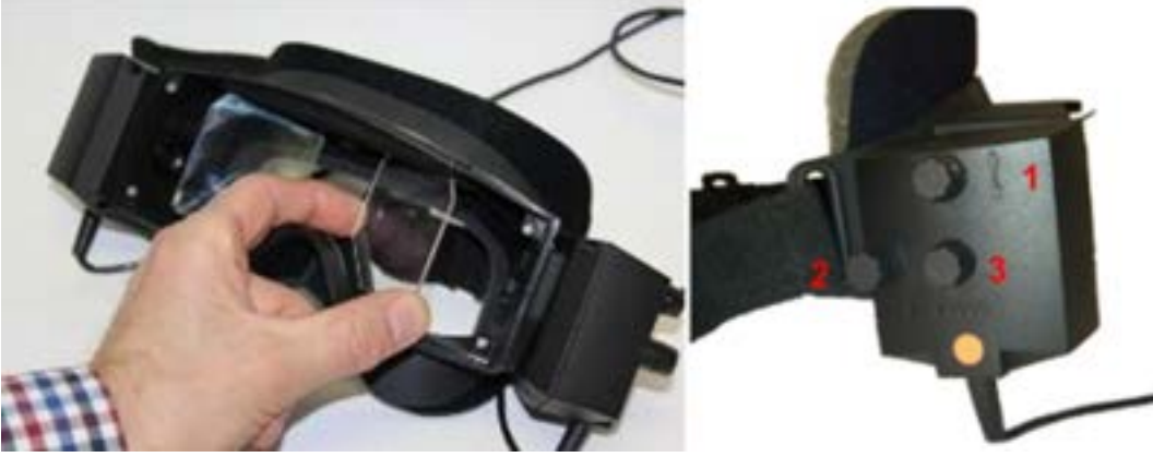
Şekil 2.6-4: Pupiller arası mesafe ayarı için ayarlanabilir IR ayınalar (solda) ve 1) dikey kamera ayarı, 2) yatay kamera ayarı, 3) kamera odak ayarı için düğmeler (sağda)
