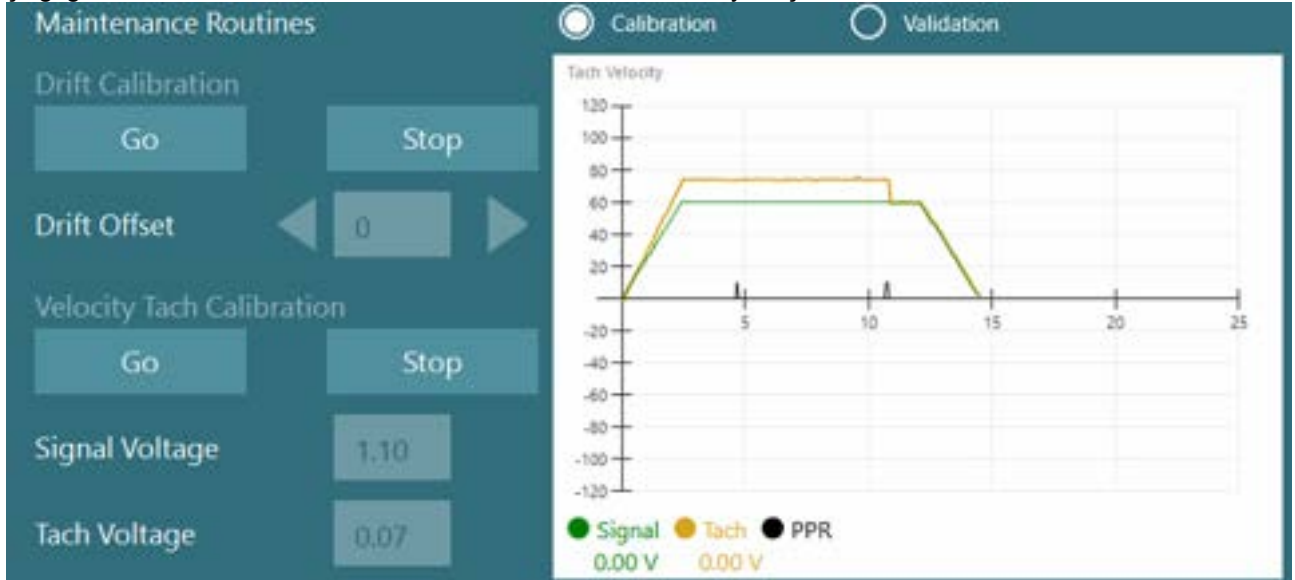
Şekil 2.6-36: Auto-Traverser/Comprehensive tipi koltuğun Sürüklenme Kalibrasyonu (Drift Calibration) ve Hız Takometresi Kalibrasyonu (Velocity Tach Calibration)
