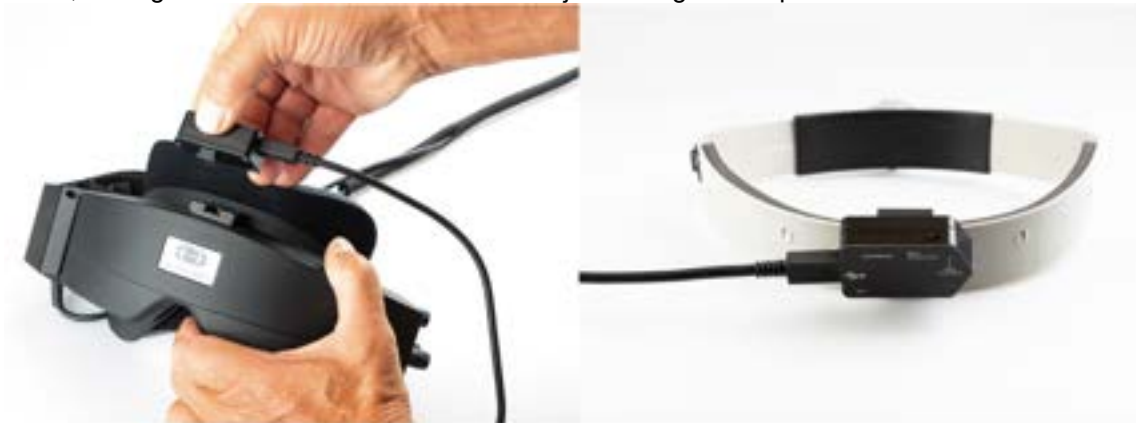
Şekil 2.6-17: VORTEQ™ IMU, yandan kameralı bir gözlüğe monte edilirken (solda) ve Dinamik Görme Keskinliği testi için taç bandına monte edilmiş olarak (sağda)
