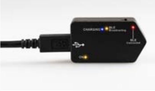
Şekil 2.6-18: VORTEQ™ IMU, LED'leri yanarken
