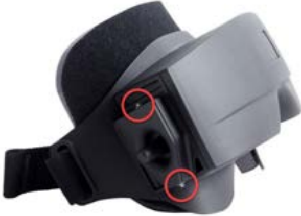
Şekil 2.6-3: Yandan kameralı bir gözlükte bulunan ve kamerayı veya resimdeki kapağı takmak amacıyla kullanılan altıgen sabitleme vidaları
