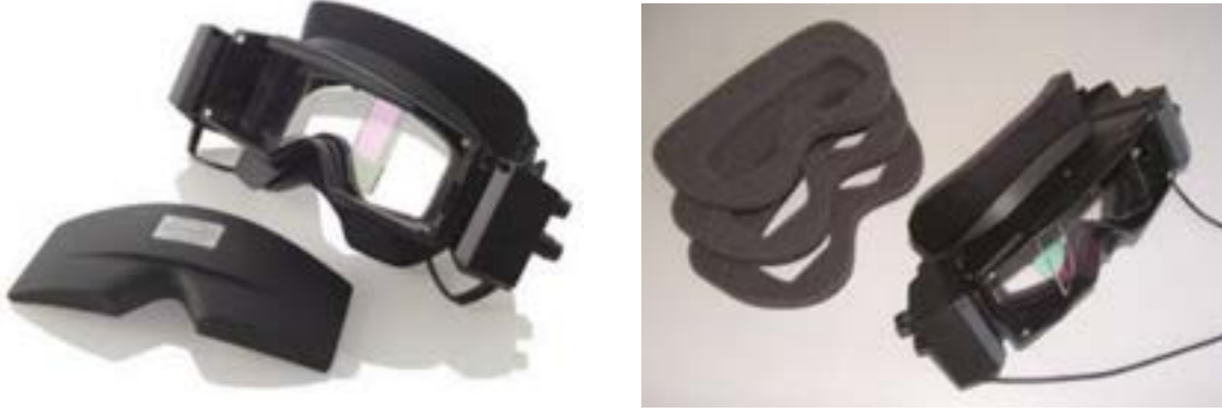
Şekil 2.6-2: Çıkarılabilir kapaklı yandan kameralı gözlük (solda) ve değiştirilebilir tek kullanımlık sünger pedler (sağda)
