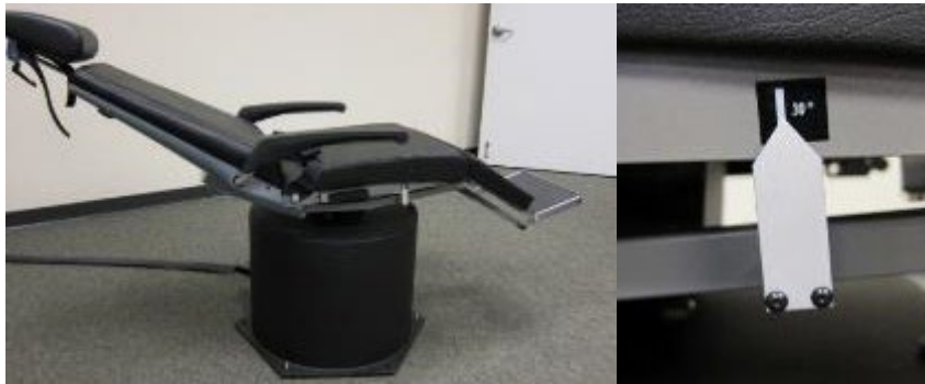
Şekil 3.9-3 Kalorik açı işareti ile kalorik testler için donatılmış yatırılabilen sandalye
