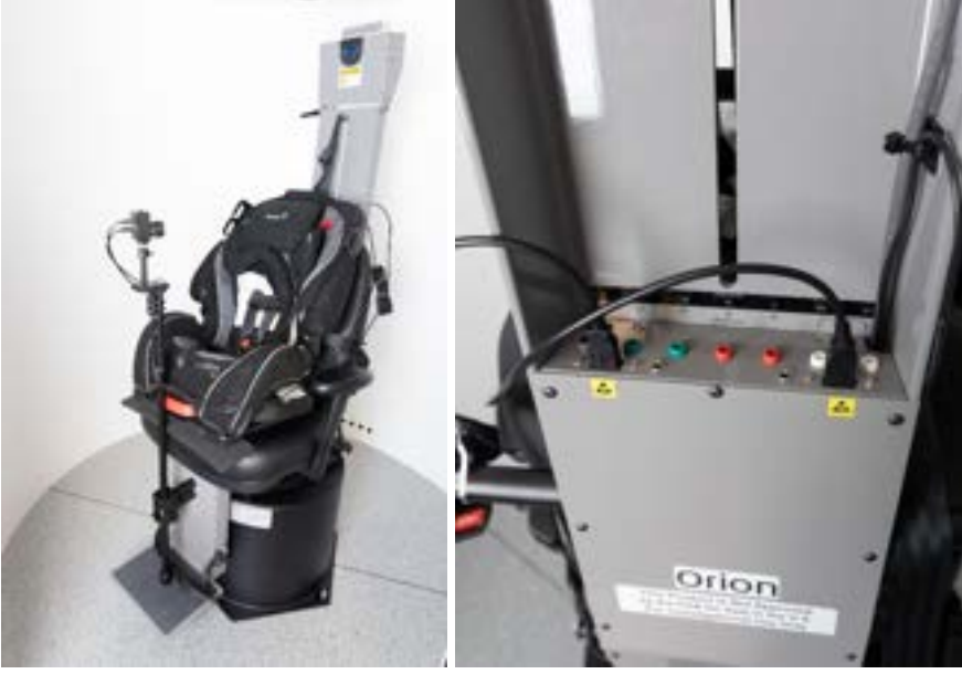
Şekil 2.6-29: Orion Auto-Traverse/Comprehensive tipi koltuğa monte edilmiş ve koltuğun arkasındaki USB bağlantı noktalarına bağlanmış pediatrik gözlem kamerası
