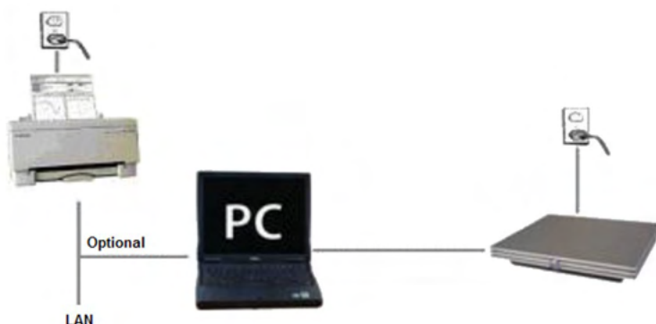
Рис. 2 Eclipse питается от сети и подключается с помощью USB кабеля к компьютеру. Компьютер может быть подключен к другим устройствам и по-прежнему обеспечивать безопасность пациента.
