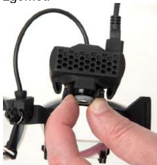
Figura 2.6-8: Ajustați focalizarea ochelarilor EyeSeeCam
