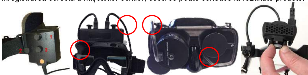
Figura 3.6-2: Reglarea focalizării la diferiți ochelari VNG și vHIT
