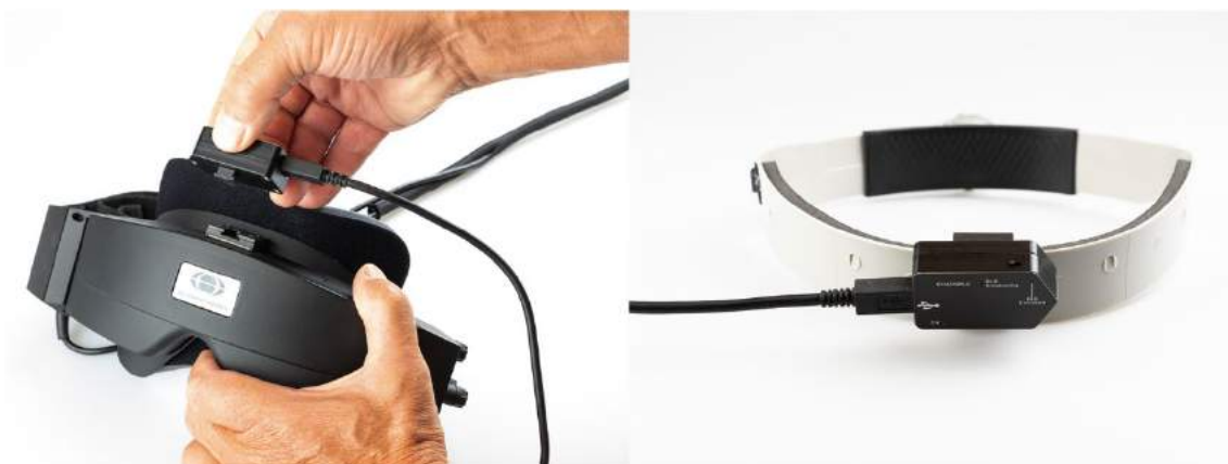
Figura 2.6-17: A doua generație VORTEQ™ IMU montat pe ochelari cu montare laterală (stânga) și montați pe o bandă de cap pentru Acuitate vizuală dinamică (dreapta)
