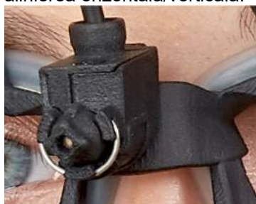
Figura 2.6-9: Laserul de calibrare de la ochelarii EyeSeeCam.
