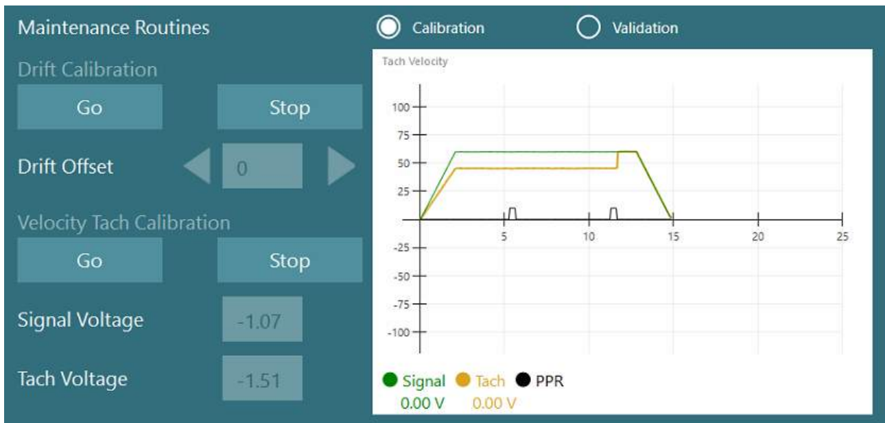
Figura 2.6-33: Calibrarea deplasării și a tahometrului de viteză
