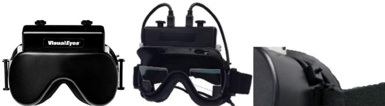
Figura 2.6-5: Ochelarii cu montare deasupra cu capac (stânga), fără capac (mijloc) și comutator start/stop pe ochelari (dreapta)
