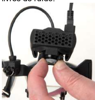
Figura 2.6-8: Ajuste do foco nos óculos EyeSeeCam
