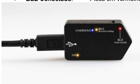
Figura 2.6-18: IMU de 2ª Geração VORTEQ™ com LEDs ligados
