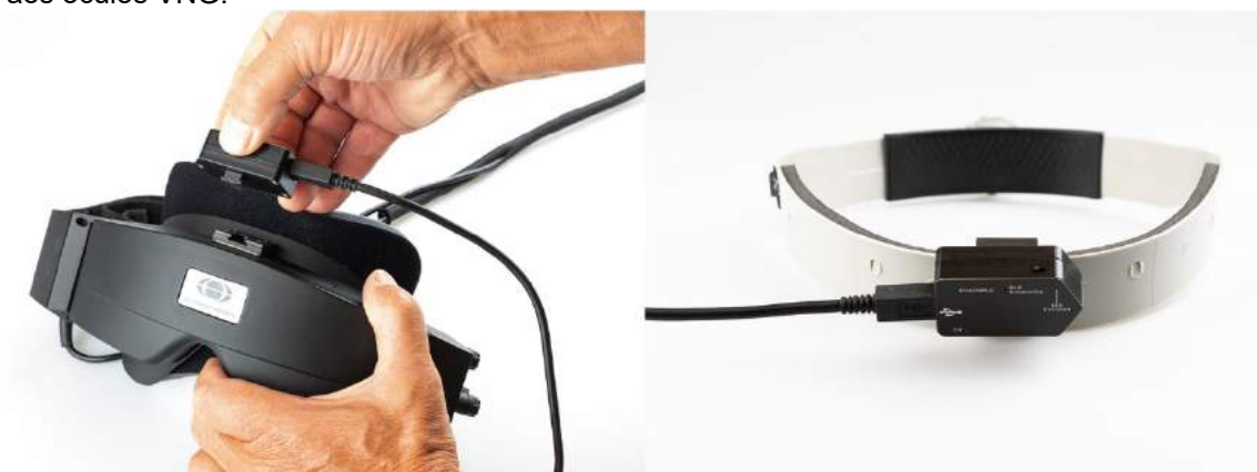
Figura 2.6-17: IMU de 2ª Geração VORTEQ™ instalada em óculos com câmeras laterais (esq.), e instalada em um arco de cabeça para a Dynamic Visual Acuity (Acuidade Visual Dinâmica) (dir.)
