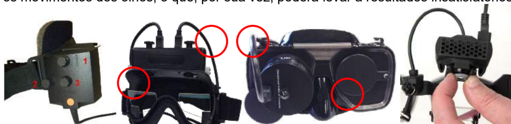
Figura 3.6-2: Ajuste de foco nos diferentes óculos VNG e vHIT.
