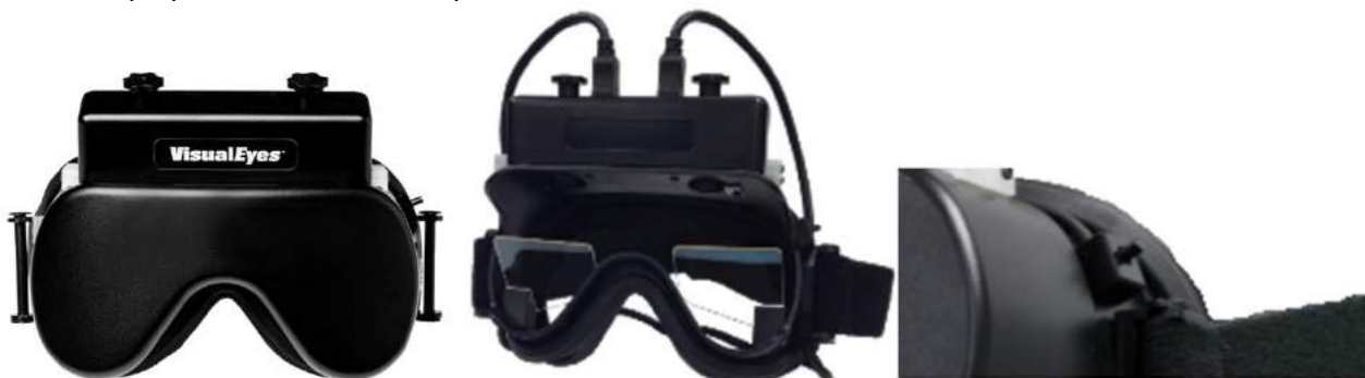
Figura 2.6-5: Óculos com câmeras superiores com tampa (esq.), sem tampa (centro), e interruptor iniciar/parar nos óculos (dir.)
