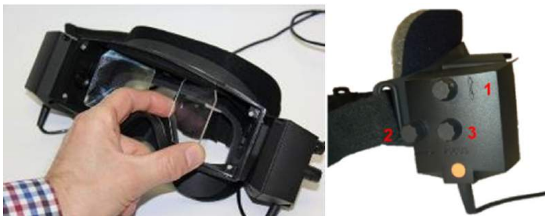
Figura 2.6-4: Espelhos de IV ajustáveis para ajustes da distância interpupilar (esq.), e botões para 1) ajuste vertical da câmera, 2) ajuste horizontal da câmera, 3) ajuste de foco da câmera (dir.)
