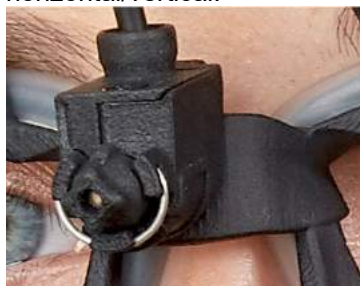
Figura 2.6-9: Laser de calibração nos óculos EyeSeeCam.
