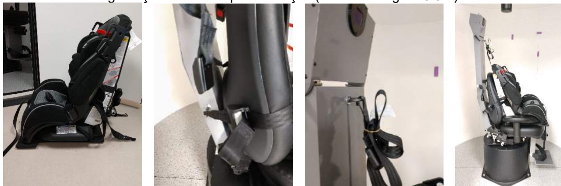
Figura 3.5-4 Sequência de imagens do ajuste do assento de carro para crianças na cadeira AT/C (da esquerda para a direita)
