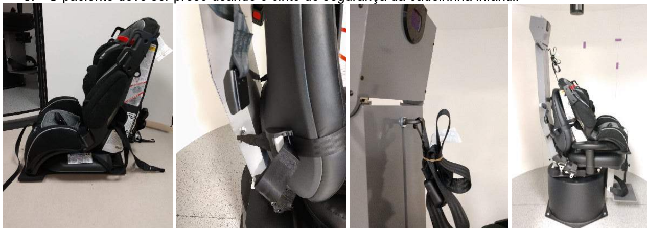
Figura 2.6-29: Sequência de imagens da instalação da cadeirinha infantil na Cadeira Auto-Traverse/Comprehensive (da esquerda para a direita)
