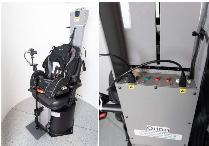
Figura 2.6-30: Câmera de observação pediátrica presa à cadeira Orion Auto-Traversal/Comprehensive e conectada às portas USB na parte traseira da cadeira
