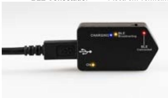
Figura 2.6-18: IMU VORTEQ™ com LEDs ligados
