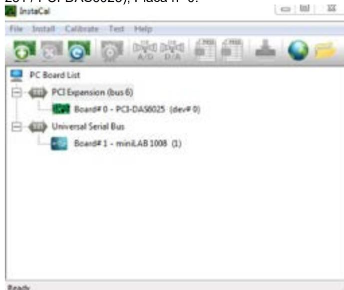
Figura 2.6-39: Detecção correta da placa do DataLink (minilab 1008) com a cadeira System 2000 Comprehensive/Reclining
