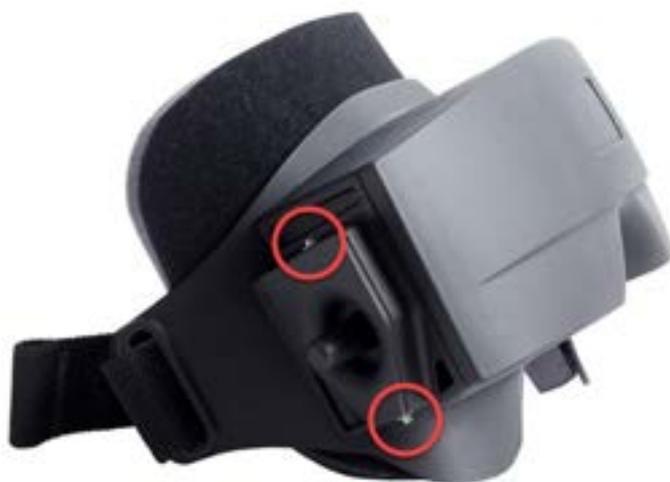
Figura 2.6-3: Parafusos de fixação sextavados na parte superior e inferior dos óculos com câmeras laterais, usados na fixação de uma câmera ou na fixação de uma proteção (na figura)
