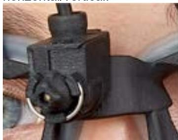
Figura 2.6-9: Laser de calibração nos óculos EyeSeeCam.
