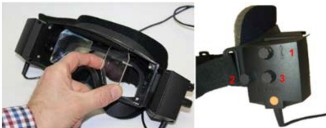
Figura 2.6-4: Espelhos de IV ajustáveis para ajustes da distância interpupilar (esq.), e botões para 1) ajuste vertical da câmera, 2) ajuste horizontal da câmera, 3) ajuste de foco da câmera (dir.)
