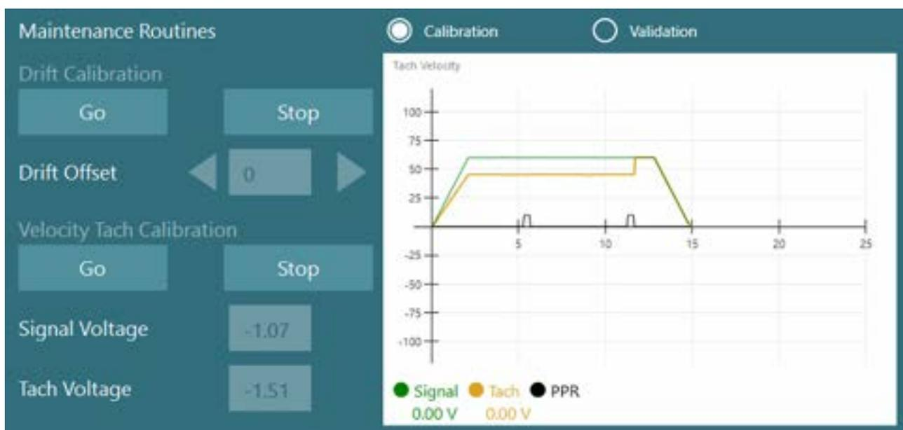
Figura 2.6-32: Desvio e calibração do tacômetro
