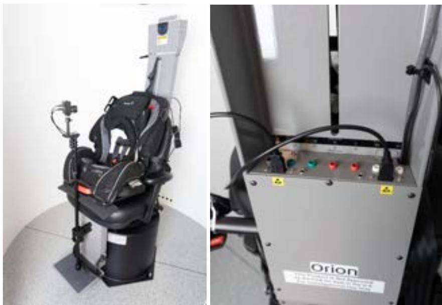
Figura 2.6-29: Câmera de observação pediátrica presa à cadeira Orion Auto-Traversal/Comprehensive e conectada às portas USB na parte traseira da cadeira
