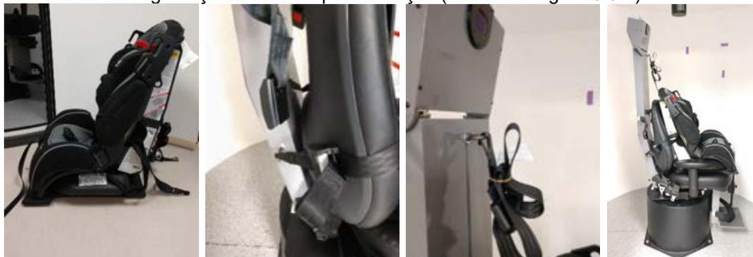
Figura 3.5-4 Sequência de imagens do ajuste do assento de carro para crianças na cadeira AT/C (da esquerda para a direita)
