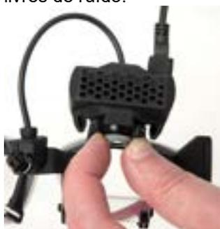
Figura 2.6-8: Ajuste do foco nos óculos EyeSeeCam
