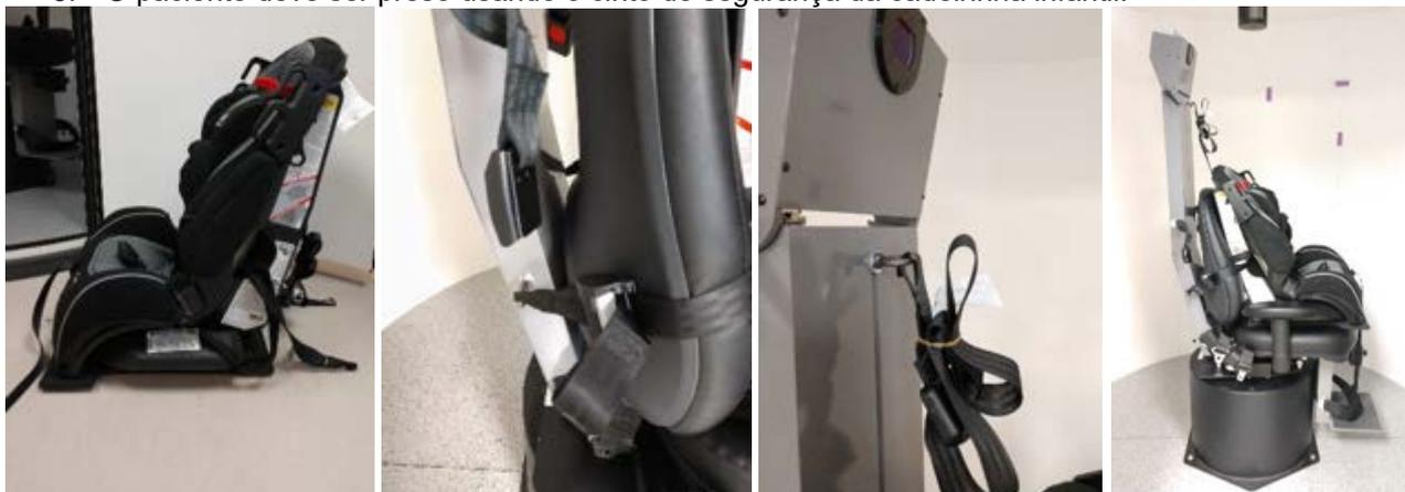
Figura 2.6-28: Sequência de imagens da instalação da cadeirinha infantil na Cadeira Auto-Traverse/Comprehensive (da esquerda para a direita)
