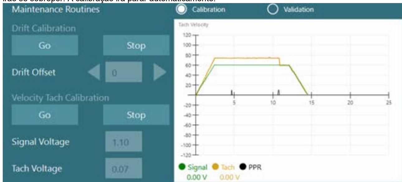
Figura 2.6-36: Calibração de desvio e calibração do tacômetro para o tambor optocinético em cadeiras Auto-Travel/Comprehensive
