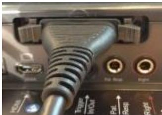
1. Localize a conexão da sonda na parte de trás da unidade.
