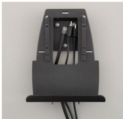
Coloque o cabo de alimentação, o cabo da impressora e o cabo USB atrás da placa de retenção. Fixe-os ao suporte antes de fazer deslizar o Titan sobre a placa de retenção.
