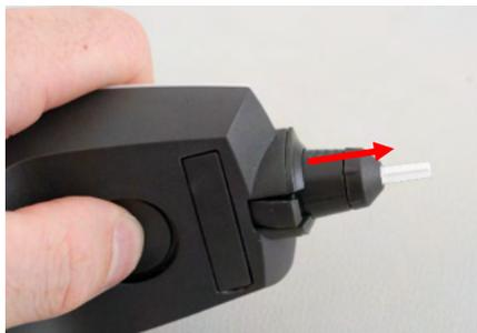
Para liberar a sonda ou um dos cabos de extensão do Titânio, pressione o botão na parte de trás do Titânio e puxe a sonda ou cabo de extensão para fora enquanto segura na base da sonda ou cabo de extensão. Não puxe diretamente o fio do cabo de extensão, pois tal pode danificar as ligações do tubo! Não puxe a extremidade da sonda diretamente, pois tal poderá parti-la!
