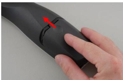
Coloque a tampa sobre o Titan e empurre-a para a frente para fechar o compartimento da bateria.
