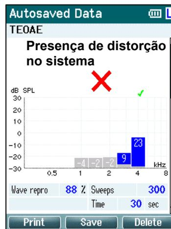
Se durante o teste for exibida uma mensagem de erro ou se uma ou mais bandas ou pontos de EOA apresentar uma marca de verificação (significando “detectado”), o teste de integridade de sonda falhou. Isso pode indicar que:
