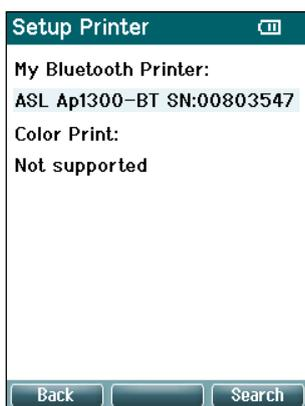
Use o botão **Superior direito** para procurar uma conexão sem fio para uma impressora. Quando for encontrada mais de uma impressão, utilize os botões **Ascendente** e **Descendente** para selecionar a impressora da sua escolha. Prima sobre o botão **superior direito** para selecionar a impressora.
