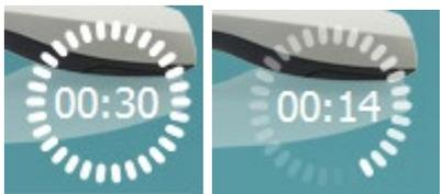
Antes de iniciar o teste, o símbolo do **Temporizador** indica após quanto tempo é que o teste DPOAE para automaticamente. Durante o teste, o temporizador conta até zero. Pode desativar a contagem decrescente clicando no temporizador durante o teste. Como resultado, o temporizador começa a contar de forma ascendente e indica quanto tempo já passou. O teste continua até o interromper manualmente.
