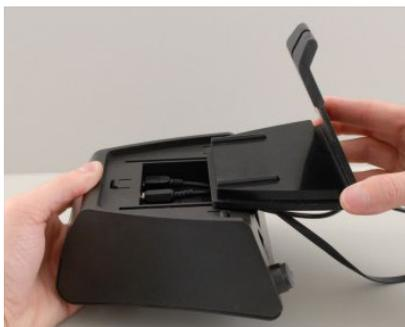
Volte a deslizar a placa traseira sobre o suporte.
