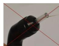
De forma a garantir medições de impedância corretas é importante certificar-se de que o sistema da sonda é mantido sempre limpo. Por conseguinte, siga as instruções abaixo ilustradas sobre como remover, por exemplo, o cerume dos pequenos canais acústicos e de pressão de ar do aparelho de exame.
