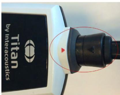
Ligue o cabo de extensão ou sonda ao Titan alinhando os triângulos vermelhos e empurrando a sonda o cabo de extensão sobre a placa de ligação.
