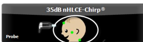
A **imagem do bebé** indica o estado de impedância dos três elétrodos (bom = verde, âmbar = fraco). Também indica a montagem para teste.
