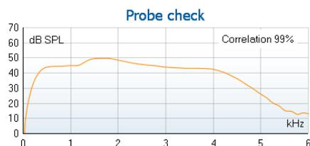
O **gráfico de verificação da sonda** permite visualizar o ajuste da sonda no ouvido do paciente antes, durante e após o teste.
