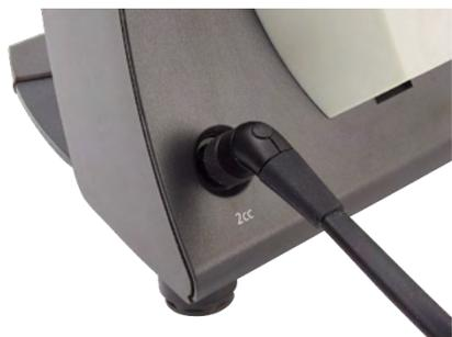
O principal objetivo do teste é garantir um resultado constante ao longo do tempo. O resultado pode variar em função das alterações da pressão barométrica, da temperatura e da umidade, mas são esperadas variações não superiores a 0,2 ml. Caso sejam medidas repentinamente variações superiores, a sonda pode estar danificada ou necessita de uma nova calibração
