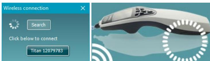
Com uma conexão sem fio adequada, o ícone sem fio ao lado do Titan indicará a intensidade da conexão. Se o Titan não puder ser alcançado, verifique se a conexão sem fio está habilitada no dispositivo, configurada para computador, e dentro de uma distância razoável do computador.
