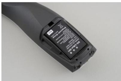
Coloque a bateria dentro do compartimento. Certifique-se de que os contactos da bateria se encontram alinhados com os contactos do interior do Titan.
