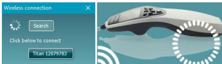
Com uma conexão sem fio adequada, o ícone sem fio ao lado do Titan indicará a intensidade da conexão. Se o Titan não puder ser alcançado, verifique se a conexão sem fio está habilitada no dispositivo, configurada para computador, e dentro de uma distância razoável do computador.
