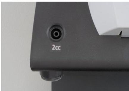
O suporte do Titan possui uma cavidade de 2cc embutido que pode ser utilizado para uma rápida verificação da validade da calibragem da sonda. Pode utilizar as cavidades de cilindros de 0.2 ml, 0.5 ml, 2.0 ml e 5.0 ml para verificações mais precisas.
