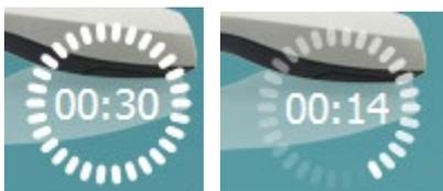
Antes de iniciar o teste, o símbolo do **Temporizador** indica após quanto tempo é que o teste ABRIS para automaticamente. Durante o teste, o temporizador conta até zero. Pode desativar a contagem decrescente clicando no temporizador durante o teste. Como resultado, o temporizador começa a contar de forma ascendente e indica quanto tempo já passou. O teste continua até o interromper manualmente.
