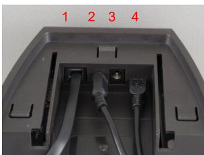
Ligue o cabo da impressora à parte traseira do suporte (1), fonte de alimentação (2) e cabo USB (4) ou cabo USB ótico (3 e 4).
