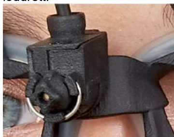
Figur 2.6-9: Kalibreringslaser på EyeSeeCam-brillene.
