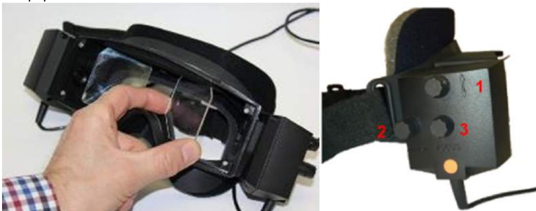
Figur 2.6-4: Justerbare IR-speil for interpupillær avstandsjustering (venstre) og knotter for 1) vertikal kamerajustering, 2) horisontal kamerajustering, 3) kamerafokusjustering (høyre)
