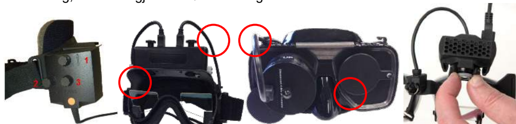
Figur 3.6-2: Fokusjustering på de forskjellige VNG- og vHIT-brillene
