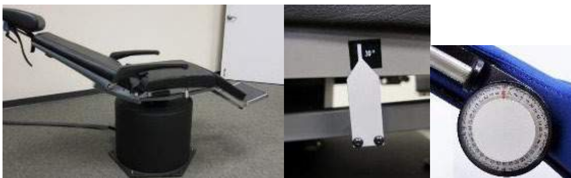
Figur 3.9-3 Stol i tilbakelent stilling for kalorisk testing med kalorisk vinkelmarkør og helningsviser.
