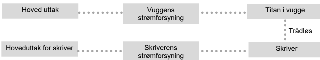
Fig. 4. Titan brukt med vuggen, medisinsk godkjent strømforsyning og en trådløs forbindelse til en PC.
