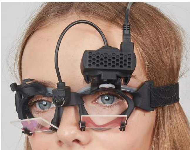
Figur 3.3.1-1vHIT-brille og kugleled til kameraet. Kalibreringslaseren sidder på brilleryggen.
