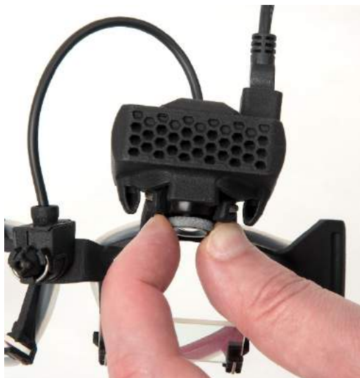
Ilustracja 3.3.3-1 Regulacja ostrości kamery
