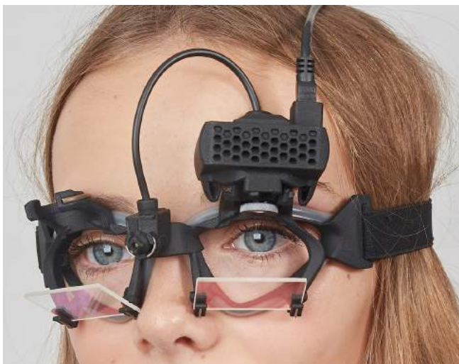
Figura 3.4.1-1 Ochelari vHIT articulație sferică cu soclu pentru cameră. Laserul de calibrare este poziționat pe puntea ochelarilor.
