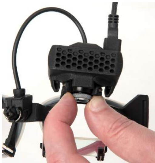
Figura 3.4.3-1 Reglarea focalizării pentru cameră
