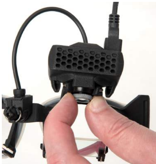
Kuva 3.3.3-1 Tarkennuksen säätö kameralle
