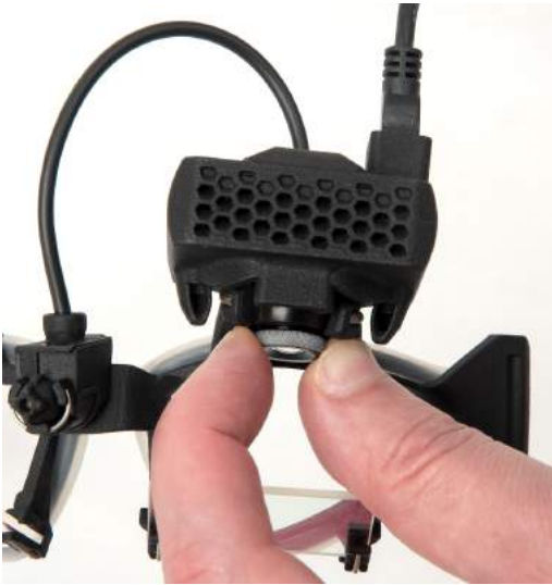
Afbeelding 3.3.3-1 Scherpstelling voor de camera
