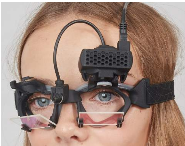
Ilustracja 3.3.1-1 Gogle vHIT oraz złącze kulowe do kamery. Laser do kalibracji jest umieszczony na mostku okularów.
