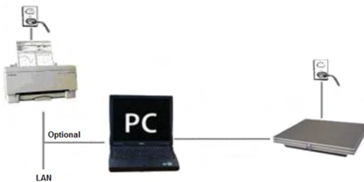
Fig. 2: Eclipse wordt aangesloten op het lichtnet en wordt via een USB-kabel op een computer aangesloten. De computer kan op andere toestellen worden aangesloten en toch de patiëntveiligheid garanderen.
