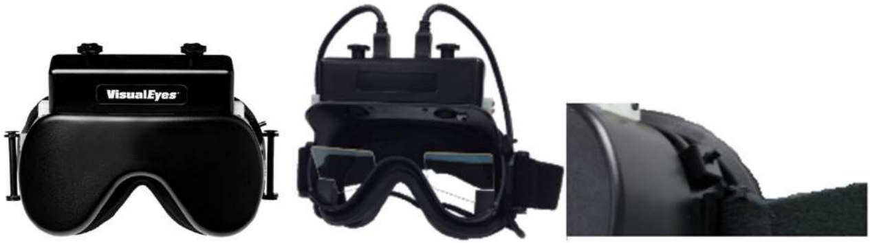
그림 2.6-5: 커버가 있거나(왼쪽) 커버가 없는(가운데) 상부 장착 고글, 고글의 시작/중지 스위치(오른쪽) 하드웨어 설정:
