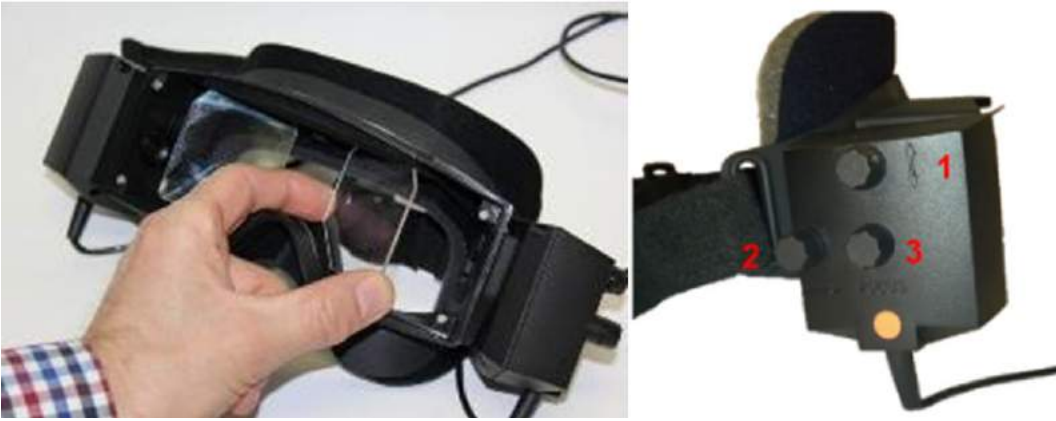
그림 2.6-4: 동공 사이 거리 조정을 위한 조절식 IR 미러(왼쪽), 1) 수직 카메라 조정, 2) 수평 카메라 조정, 3) 카메라 초점 조정을 위한 손잡이(오른쪽)
