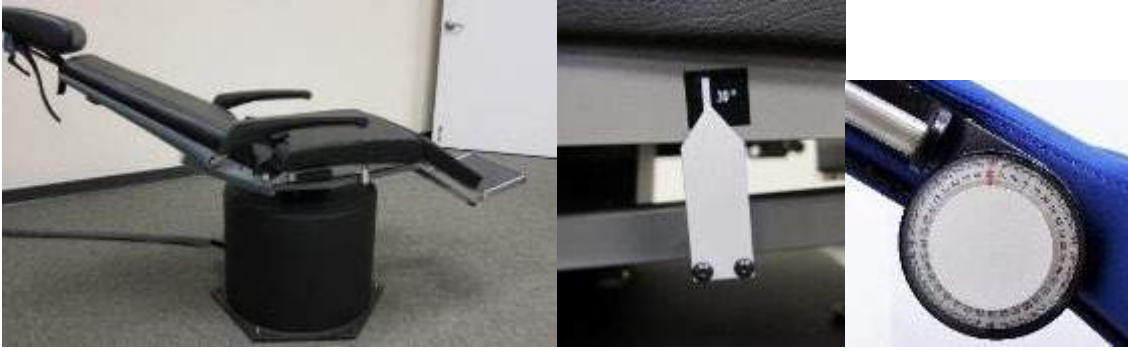
그림 3.9-3 온도안전검사를 위한 온도 각도 마커 및 경사 다이얼이 있는 리클라이닝 의자
