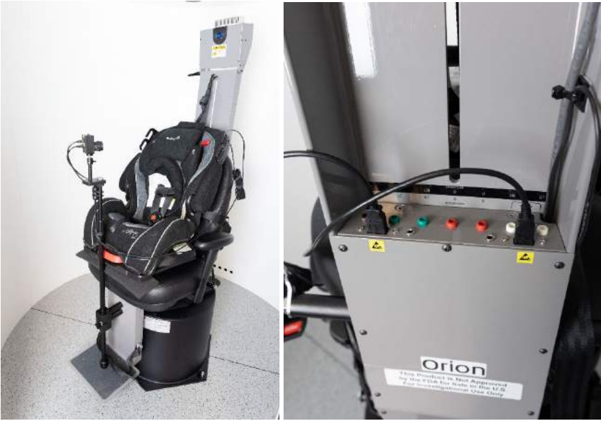
그림 2.6-30: Orion Auto-Traverse/Comprehensive 의자에 부착되고 의자 뒷면의 USB 포트에 연결된 소아 관찰 카메라
