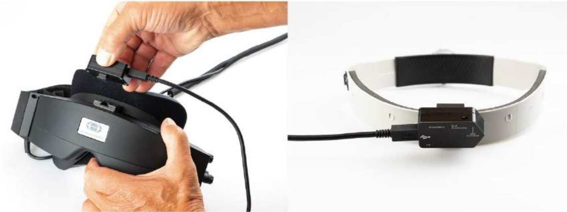
그림 2.6-17: 측면 마운트 고글에 장착된 VORTEQ™ 2 세대 IMU(왼쪽), 동체시력용 헤드밴드에 장착(오른쪽) VORTEQ™ 2 세대 IMU 는 기기의 상태를 설명하는 4 개의 LED 를 포함합니다.
