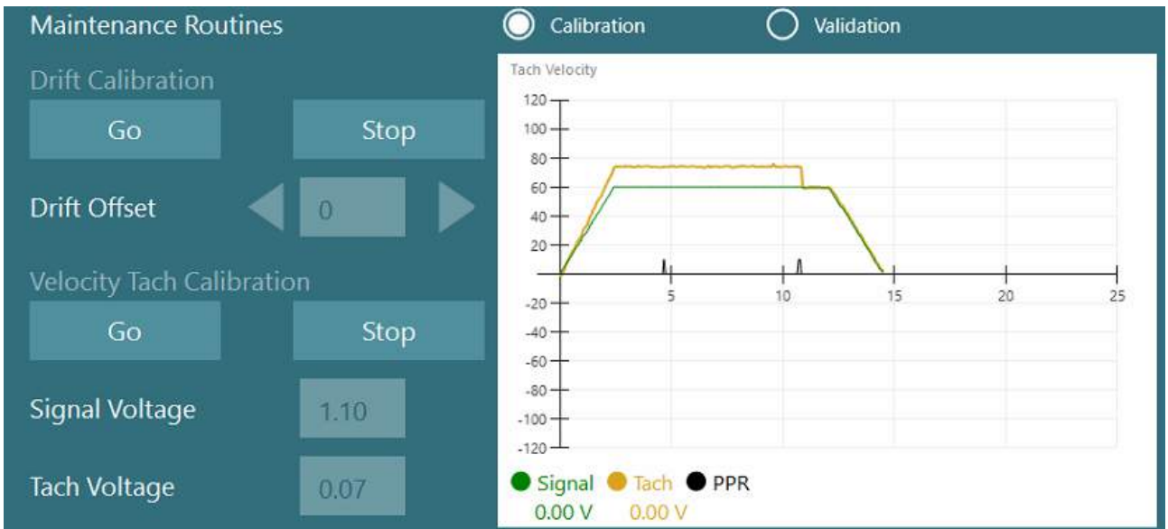
그림 2.6-37: Auto-Traverser/Comprehensive chair 에서 눈운동검사통에 대한 드리프트 보정 및 속도계 보정
