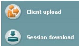
「被検者アップロード（**Client upload**）」はデータベース（Noah、OtoAccess）から被検者情報をアップロードする場合に使用します。内部メモリには、被検者は最大 1,000 件、セッション（検査結果）は最大 50,000 件を保存できます。
