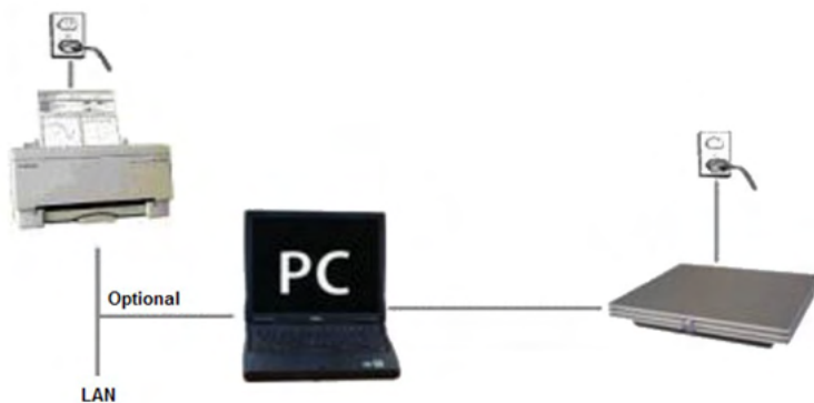
Fig. 2: Eclipse è alimentato dalla rete elettrica ed è connesso a un computer tramite un cavo USB. Il computer può essere collegato ad altri dispositivi pur continuando a preservare la sicurezza del paziente.
