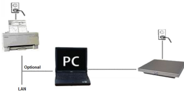
Fig.2: Eclipse diberi daya dari sumber listrik dan terhubung ke komputer melalui kabel USB. Komputer dapat dipasangkan ke perangkat lain dan tetap menjaga keselamatan pasien.
