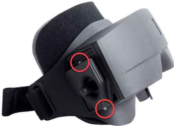
Gambar 2.6-3: Sekrup fiksasi segi enam pada bagian atas dan bawah kaca mata dudukan samping, digunakan untuk fiksasi kamera atau fiksasi penutup (dalam gambar)
