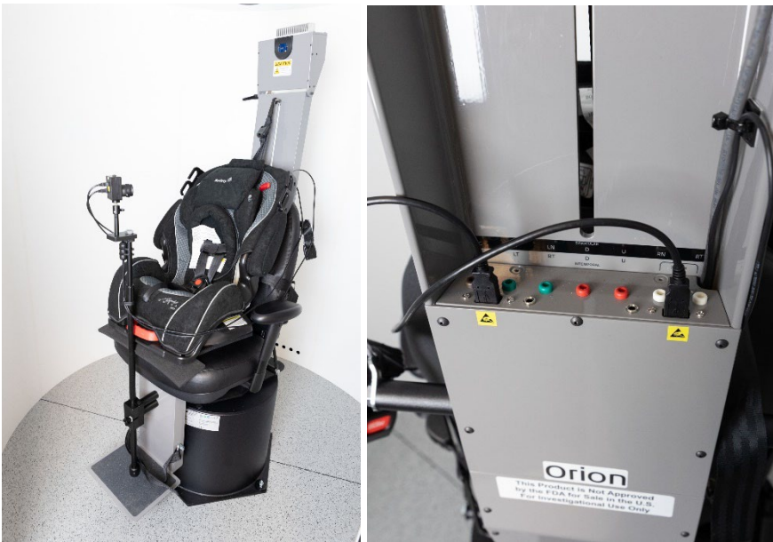
Gambar 2.6-29: Kamera observasi pediatrik yang terpasang dikursi Orion Auto-Traversal/Comprehensive dan terhubung ke port USB di bagian belakang kursi
