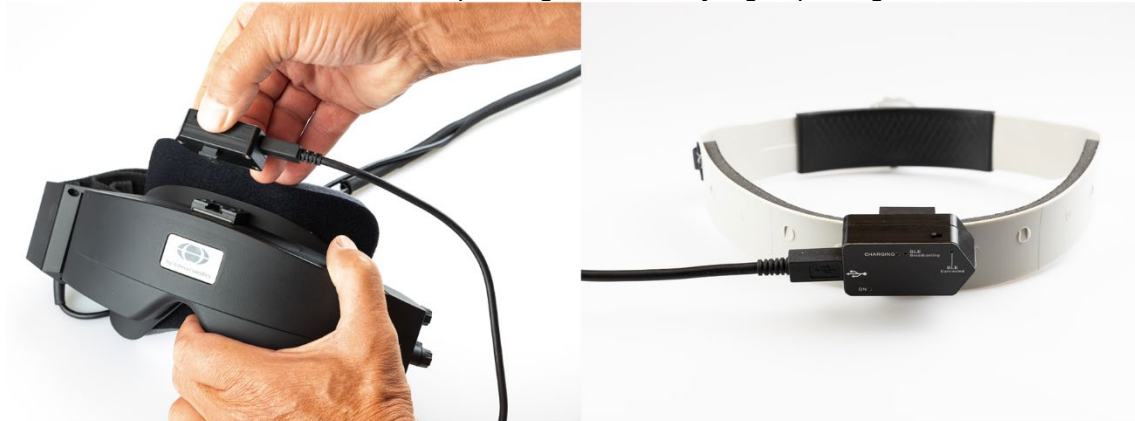
Gambar 2.6-17: VORTEQ™ IMU dipasang di kacamata dudukan samping (kiri), dan dipasang di ikat kepala untuk Ketajaman Visual Dinamis (kanan)
