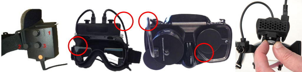
Gambar 3.6-2: Penyesuaian fokus pada kacamata VNG dan vHIT yang berbeda
