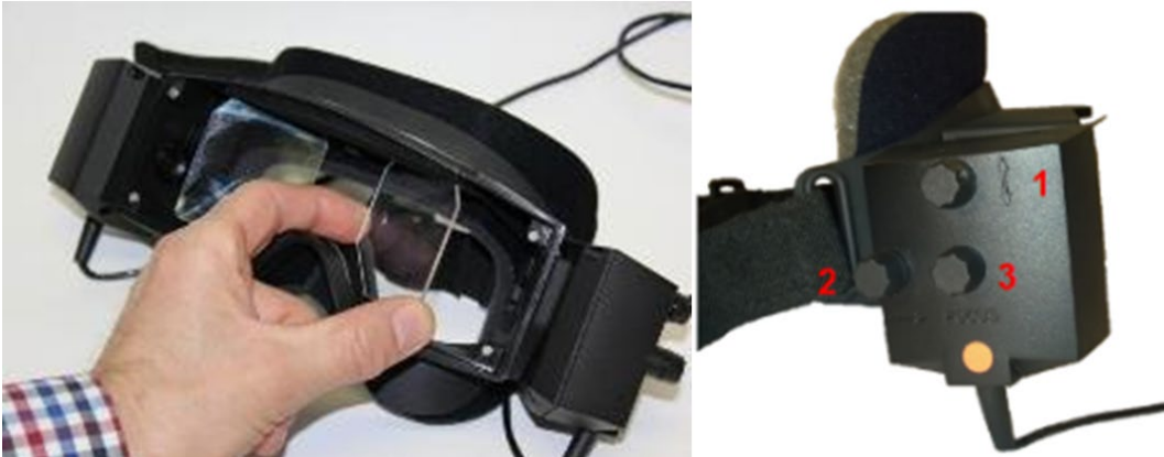
Gambar 2.6-4: Cermin IR yang dapat disesuaikan untuk penyesuaian jarak antarpupil (kiri), dan kenop untuk 1) penyesuaian kamera vertikal, 2) penyesuaian kamera horizontal, 3) penyesuaian fokus kamera (kanan)
