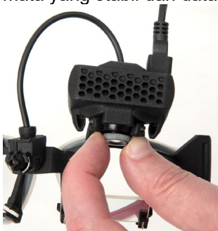
Gambar 2.6-8: Penyesuaian fokus pada kacamata EyeSeeCam
