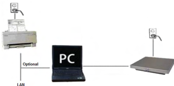
Imagen 2: Eclipse funciona a través de la red eléctrica y se conecta a un ordenador mediante un cable USB. El ordenador puede estar unido a otros dispositivos y seguir garantizando la seguridad del paciente.
