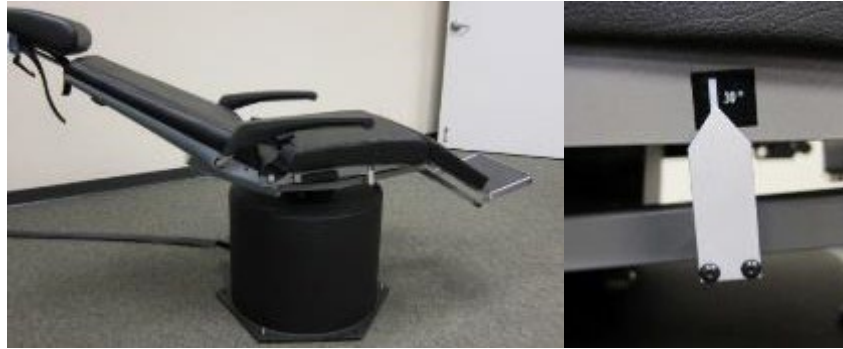
Abbildung -3.9-3: Zurückgeneigter Stuhl für Kaloriktests mit Winkelkennzeichnung für kalorische Tests
