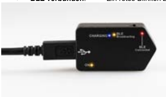
Abbildung 2.6-18: VORTEQ™ IMU-Sensor mit aktiven LEDs
