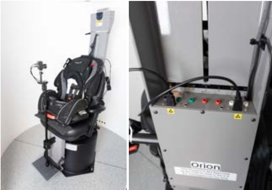
Abbildung 2.6-29: Pädiatrische Beobachtungskamera an einem Orion Auto-Traversal-/Comprehensive-Stuhl, angeschlossen an die USB-Anschlüsse an der Rückseite des Stuhles
