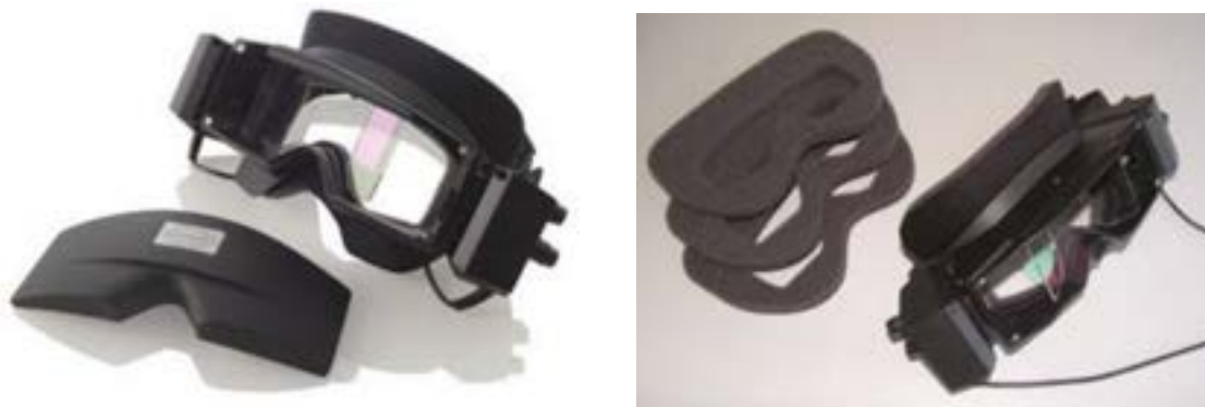
Abbildung 2.6-2: Brille mit seitlicher Kamera und abnehmbarer Abdeckung (links) und austauschbare Einweg-Schaumstoffpolster (rechts)
