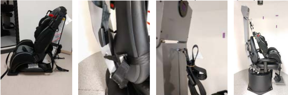
Abbildung 3.5-4 Aufeinander folgende Bilder zur Platzierung eines Kindersitzes auf einem AT/C-Stuhl (von links nach rechts)
