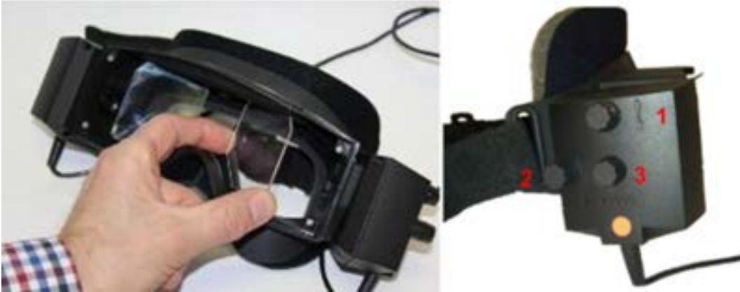
Abbildung 2.6-4: Einstellbare IR-Spiegel zur Einstellung auf unterschiedliche Pupillenabstände (links) und Drehknöpfe für 1) die vertikale Einstellung der Kamera, 2) die horizontale Einstellung der Kamera, 3) die Einstellung der Bildschärfe (rechts)
