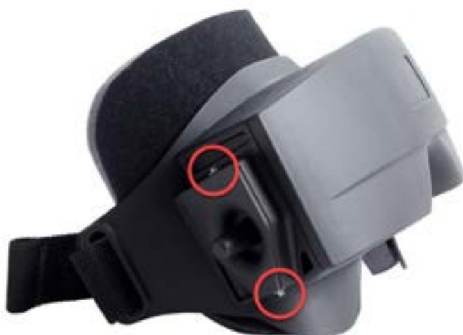
Abbildung 2.6-3: Inbusschrauben auf der Ober- und Unterseite der Brille mit seitlicher Kamera, zu verwenden für die Befestigung einer Kamera oder einer Abdeckung (vgl. Abbildung)
