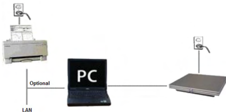
Fig. 2: Eclipse drives af strøm fra el-nettet og forbindes til en computer via et USB-kabel. Computeren kan tilsluttes andre enheder og stadigvæk opretholde patientsikkerheden.
