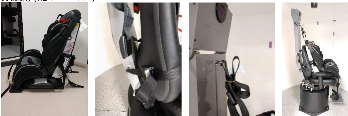
Obrázek 3.5-4 Sekvenční obrázky upevnění dětské autosedačky na křesle AT/C (zleva doprava)
