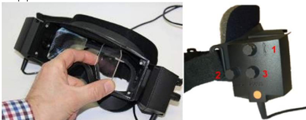
Obrázek 2.6-4: Nastavitelná infračervená zrcátka pro nastavení mezipupilární vzdálenosti (vlevo) a točítka pro 1) vertikální nastavení kamery, 2) horizontální nastavení kamery, 3) zaostření kamery (vpravo)
