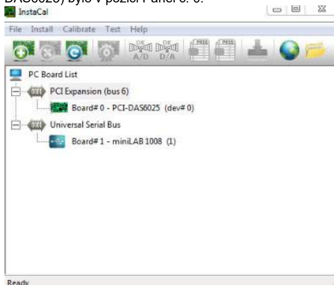
Obrázek 2.6-40: Správná detekce panelu DataLink (minilab 1008) s křeslem System 2000 Comprehensive/Reclining
