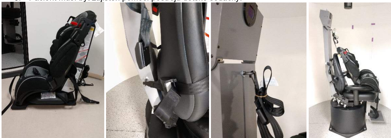
Obrázek 2.6-29: Sekvenční obrázky upevnění dětské autosedačky na křesle Auto-Traversal/Comprehensive (zleva doprava)
