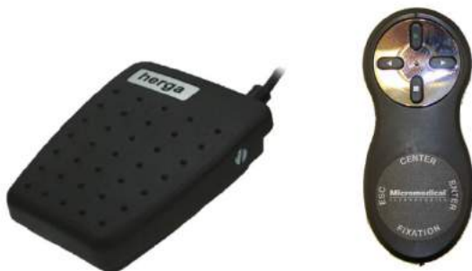
Obrázek 2.6-12: Nožní spínač (vlevo) a RF dálkové ovládání (vpravo)
