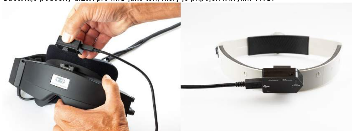
Obrázek 2.6-17: VORTEQ™ 2. generace IMU se montuje na brýle s boční montáží (vlevo) a na členku pro testování dynamické zrakové ostrosti (vpravo)
