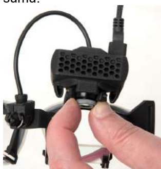
Obrázek 2.6-8: Zaostření na brýlích EyeSeeCam
