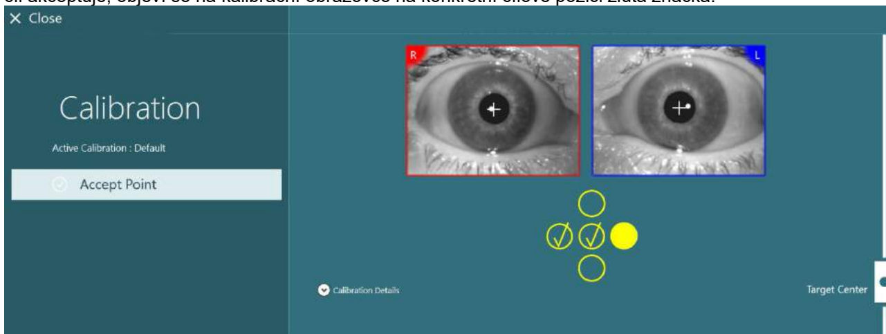
Obrázek 3.7-2: Kalibrační obrazovka během standardního kalibračního postupu. Na přijatých cílových pozicích se objeví žluté zaškrťovací značky
