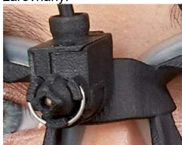
Obrázek 2.6-9: Kalibrační laser v brýlích EyeSeeCam.
