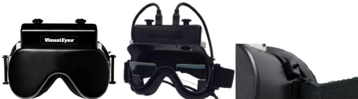
Obrázek 2.6-5: Brýle s horní montáží s krytem (vlevo), bez krytu (uprostřed) a se spínačem start/stop (vpravo)
