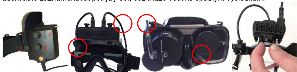
Obrázek 3.6-2: Nastavení zaostření na různé brýle VNG a vHIT
