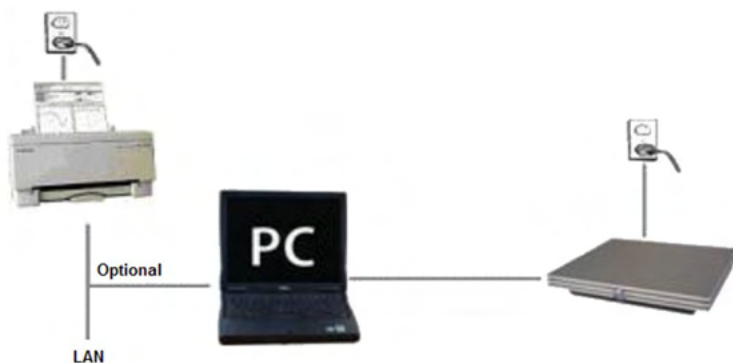
Фиг.2: Устройството Eclipse се захранва от електрическата мрежа и е свързано към компютър чрез USB кабел. Компютърът може да се свърже с други устройства и въпреки това да поддържа безопасността на пациента.
