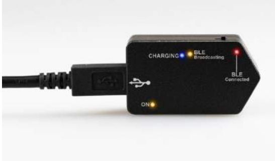
图 2.6-18: VORTEQ™ 第二代 IMU LED 亮起
