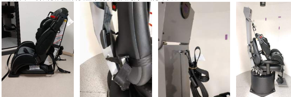
图 3.5-4 将婴儿座椅安装到 AT/C 转椅的顺序图（从左到右）
