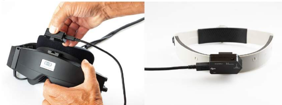
图 2.6-17: 分别安装在侧置眼罩 (左) 和头带 (右) 上, 以用于动态视敏度测试的 VORTEQ™ 第二代 IMU
