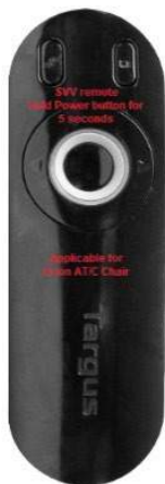
图 2.6-25: Orion Auto-Traversal/Comprehensive 转椅的 SVV 遥控器
