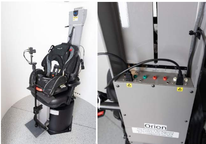
图 2.6-30: 将儿童监视摄像头连接到 Orion Auto-Traversal/Comprehensive 转椅和椅背 USB 端口
