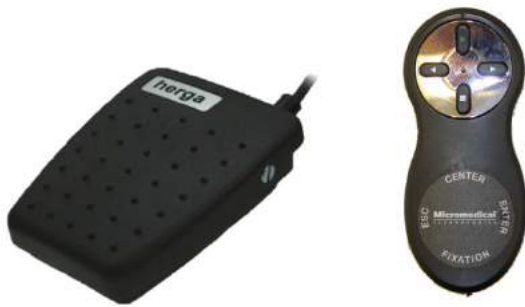
图 2.6-12: 脚踏开关 (左) 和 RF 遥控器 (右)
