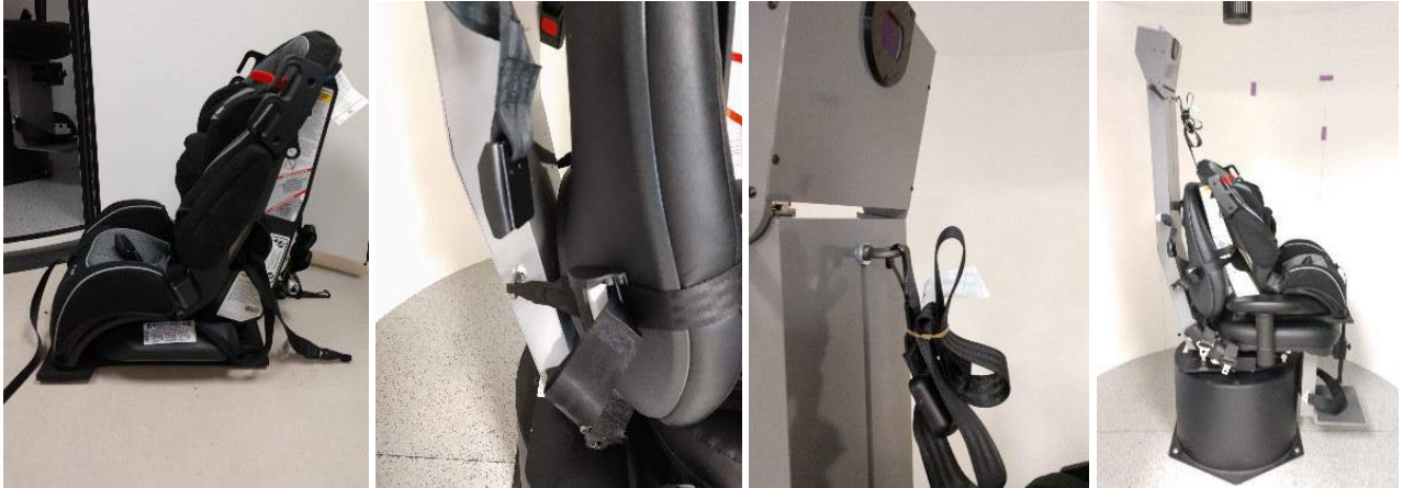
图 2.6-29：在 Auto-Traverse/Comprehensive 转椅上安装婴儿座椅的顺序图（从左到右）
