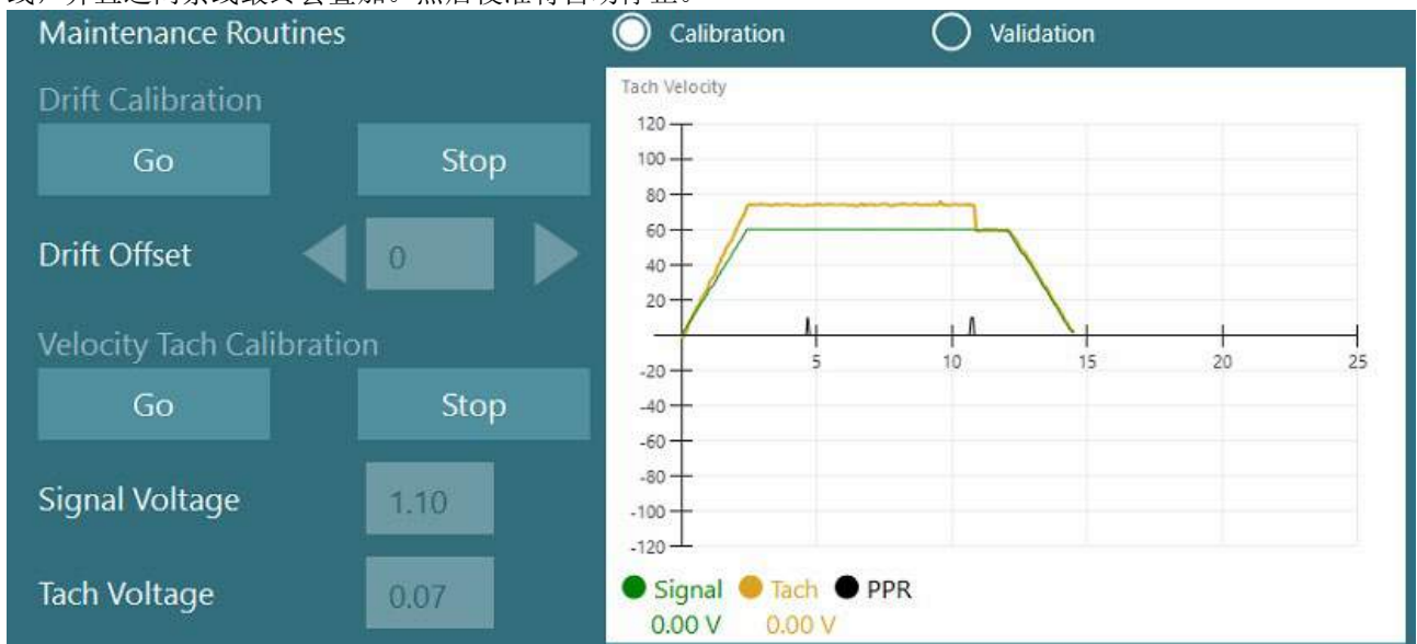
图 2.6-37: 对 Auto-Traverser/Comprehensive 中的视动鼓进行漂移校准和速度计校准
