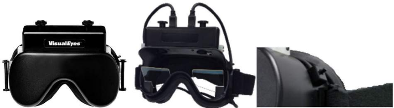
图 2.6-5：带有罩盖的顶置眼罩（左），不带罩盖的眼罩（中），以及眼罩上的启动/停止开关（右）
