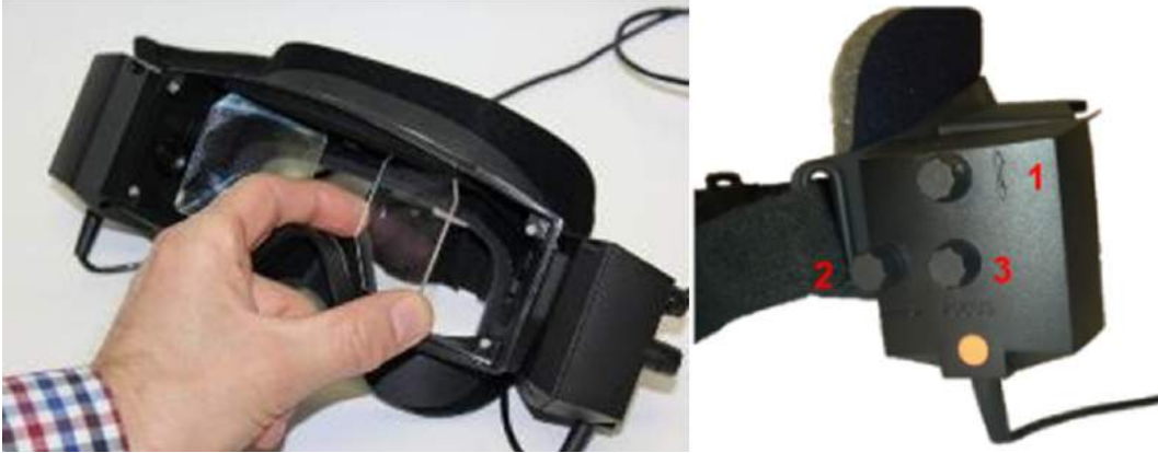
图 2.6-4：用于调节瞳距的可调红外反射镜（左），以及用于 1) 垂直调节摄像头、2) 水平调节摄像头、3) 调节摄像头焦距的旋钮（右）
