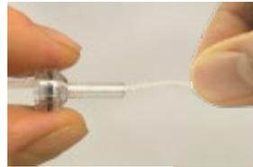
步骤 2：从内部将清洁刷硬的一端旋入一个管道。将清洁丝绵完全拉过探尖管。清洁这三个探尖管。用后丢掉丝绵。
