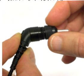
步骤 2：从内部将清洁刷硬的一端旋入一个管道。将清洁丝绵完全拉过探针管。
