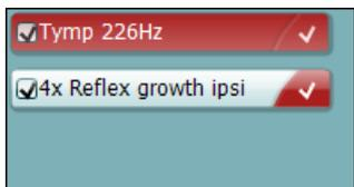
F 协议列表显示当前查看的测试类型，复选框中指示的是启动测试后要进行的测试。
