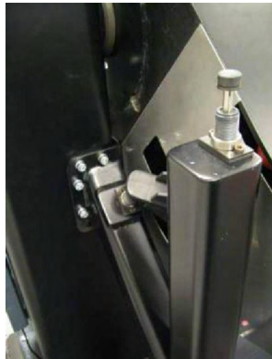
Упор зчепиться із нижнім гідроамортизатором при виконанні DPRM вертикального каналу.
