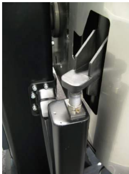
Упор зчепиться із верхнім гідроамортизатором при DPRM горизонтального каналу.
