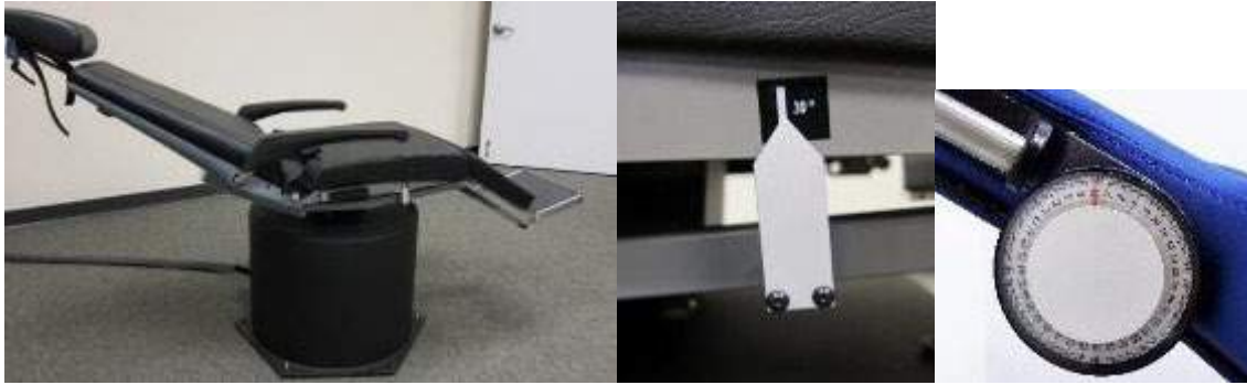
Şekil 3.9-3 Kalorik açı işareti ve eğim kadranı ile kalorik testler için donatılmış yatırılabilen sandalye
