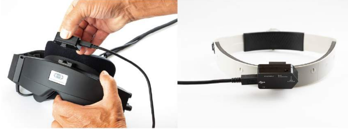
Şekil 2.6-17: 2. nesil VORTEQ™ IMU, yandan kameralı bir gözlüğe monte edilirken (solda) ve Dinamik Görme Keskinliği testi için taç bandına monte edilmiş olarak (sağda)
