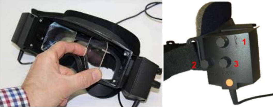
Şekil 2.6-4: Pupiller arası mesafe ayarı için ayarlanabilir IR aynalar (solda) ve 1) dikey kamera ayarı, 2) yatay kamera ayarı, 3) kamera odak ayarı için düğmeler (sağda)
