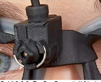
Şekil 2.6-9: EyeSeeCam gözlüğün kalibrasyon lazeri.
