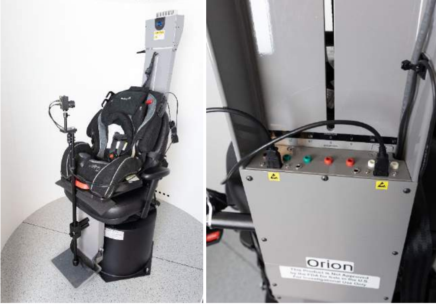
Şekil 2.6-30: Orion Auto-Traverse/Comprehensive tipi koltuğa monte edilmiş ve koltuğun arkasındaki USB bağlantı noktalarına bağlanmış pediatrik gözlem kamerası
