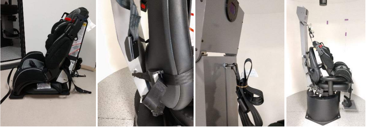
Şekil 2.6-29: Bebek araç koltuğunun Auto-Traverse/Comprehensive Chair tipi koltuğa bağlanması (sırasıyla soldan sağa doğru)
