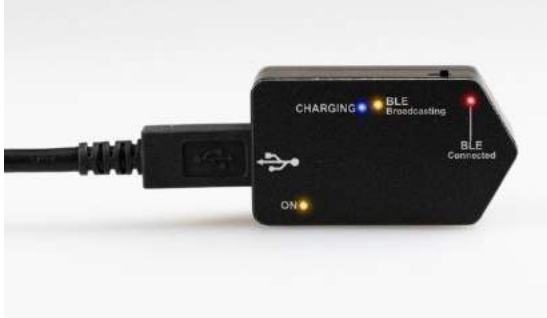
Şekil 2.6-18: 2. nesil VORTEQ™ IMU, LED'leri yanarken
