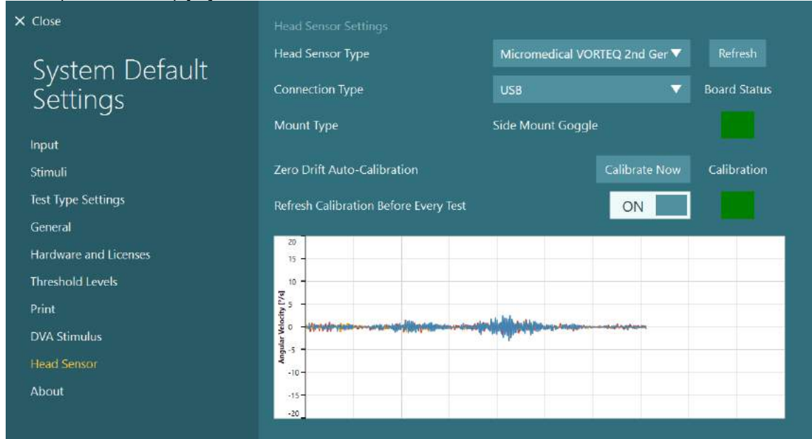
Şekil 2.6-19: Varsayılan Sistem Ayarları (System Default Settings) > Baş Sensörü (Head Sensor) bölümünde 2. nesil VORTEQ™ IMU'nun yapılandırılması
