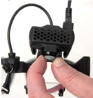
Şekil 2.6-8: EyeSeeCam gözlüğün odaklama ayarı
