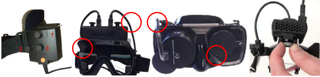
Şekil 3.6-2: Çeşitli VNG ve vHIT gözlüklerin odaklama ayarı
