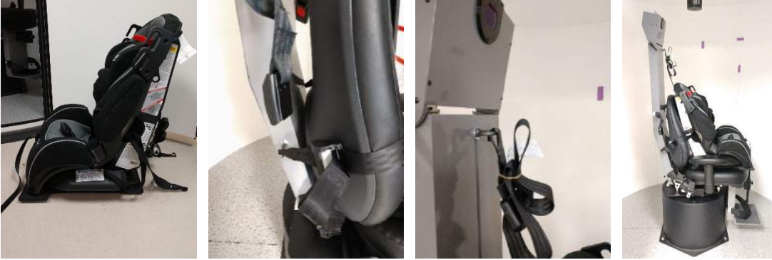
Şekil 3.5-4 Bebek araç koltuğunun AT/C tipi koltuğa bağlanması (sırasıyla soldan sağa doğru)
