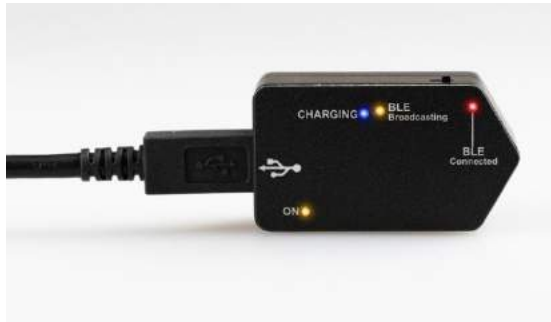
Figur 2.6-18: VORTEQ™ 2 nd Generation IMU med tända lysdioder
