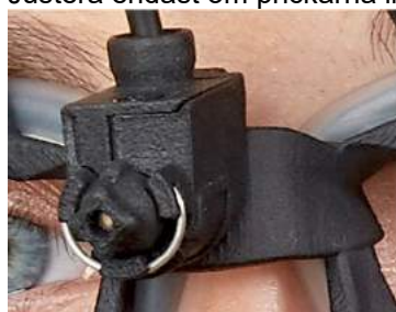
Figur 2.6-9: Kalibreringslaser i EyeSeeCam-glasögon.
