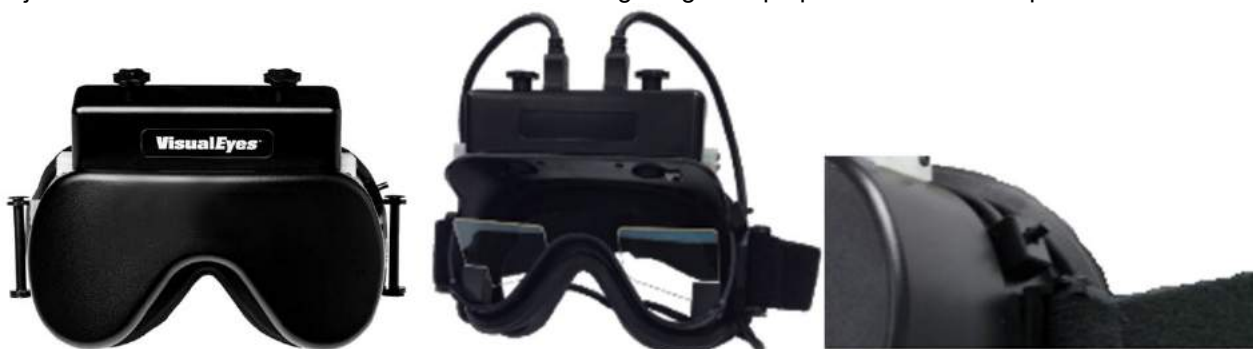
Figur 2.6-5: Toppmonterade glasögon (vänster), utan skydd (mitten), och start-/stopp-brytare på glasögon (höger)
