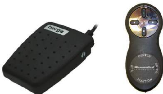
Figur 2.6-12: Fotomkopplare (vänster) och RF-fjärrkontroll (höger)
