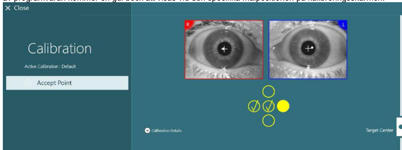
Figur 3.7-2: Kalibreringsskärm under standardkalibreringsproceduren. Accepterade målpositioner markeras med gula bockar.
