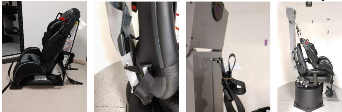
Figur 3.5-4 Sekventiella bilder av placering av barnet i en AT/C-stol (vänster till höger)
