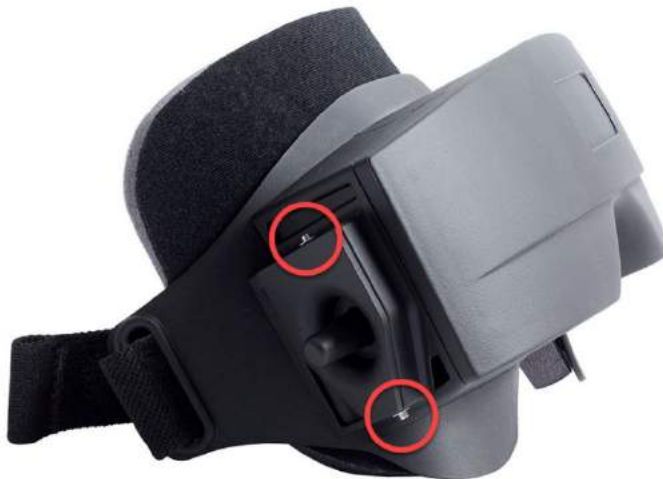
Figur 2.6-3: Kamera och skydd fixeras med sexkantskruvar på de sidomonterade glasögonens under- och översida (se bilden)
