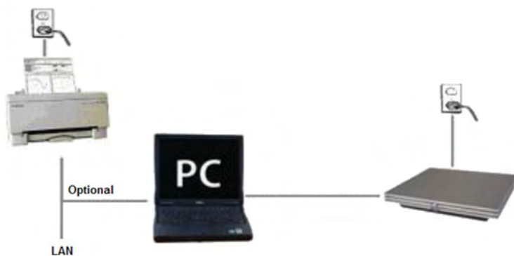
Fig. 2: Eclipse strömförsörjs från ett nätuttag och är ansluten till en dator med en USB-kabel. Datorn kan anslutas till andra enheter med upprätthållen patientsäkerhet.
