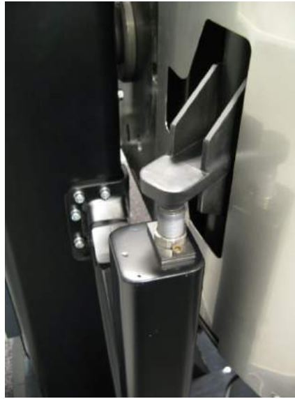
Stoppet utförs med den övre hydrauliska stötdämparen under DPRM för horisontella bäggångar.
