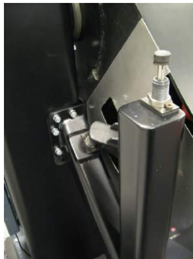
Stoppet utförs med den nedre hydrauliska stötdämparen under DPRM för vertikala bäggångar.
