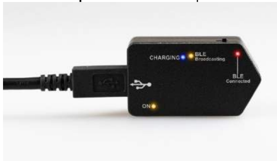
Slika 2.6-18: VORTEQ™ IMU 2. generacije sa uključenim LED lampicama
