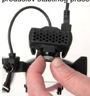
Slika 2.6-8: Podešavanje fokusa na EyeSeeCam naočarima
