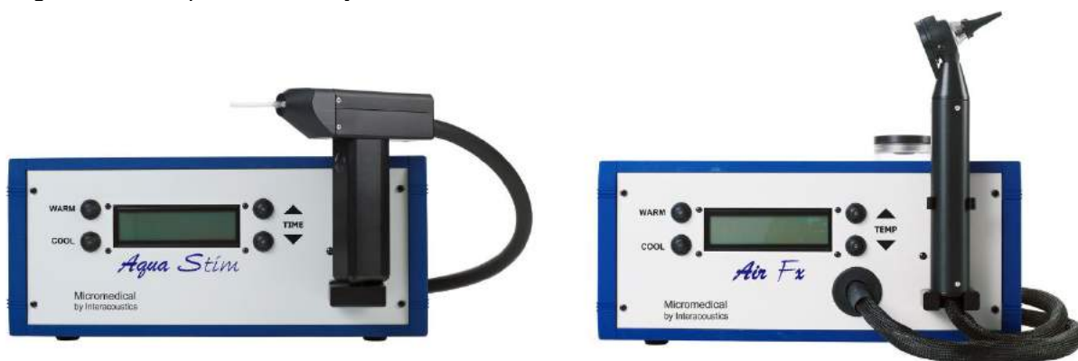
Slika 2.6-13: AquaStim za irigaciju vode (levo) i AirFx za irigaciju vazduha (desno)
