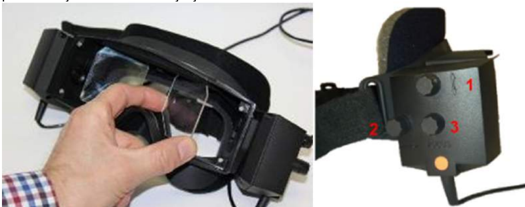
Slika 2.6-4: Podesiva IC ogledala za podešavanje rastojanje između zenica (levo), kao i dugmad za 1) vertikalno podešavanje kamere, 2) horizontalno podešavanje kamere, 3) podešavanje fokusa kamere (desno)
