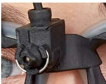
Slika 2.6-9: Kalibracioni laser na EyeSeeCam naočarima.
