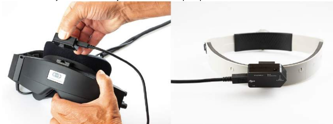
Slika 2.6-17: VORTEQ™ IMU 2. generacije koji se montira na naočare sa montiranjem sa strane (levo) i montirano na traku za glavu za dinamičku vizuelnu oštrinu (desno)
