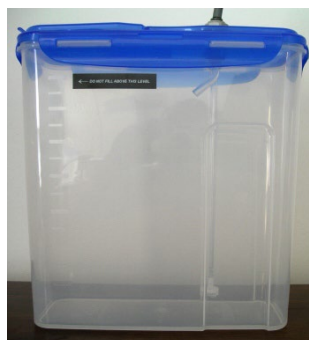
Slika 4 Spoljni rezervoar sa filterom za nakupljanje
