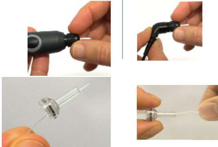
Korak 2: Napeljite togi konec čistilne krtačke v eno od cevi iz notranje strani. Čistilno nitko v celoti povlecite skozi cev konice sonde. Očistite vse tri cevi. Nitko po uporabi zavrzite.
