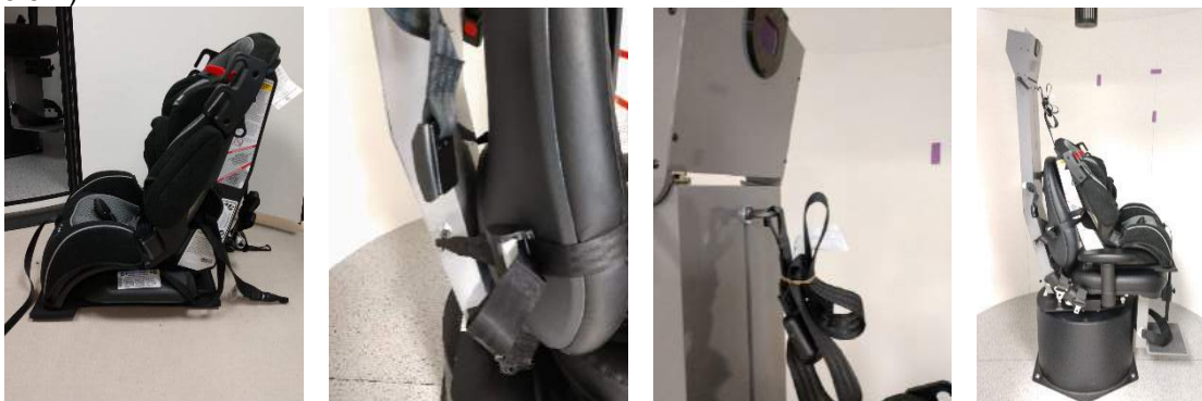
Рис. 3.5-4 Последовательность установки детского автокресла на кресле AT/C (слева направо)
