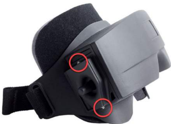
Рис. 2.6-3: Шестигранные фиксирующие винты в верхней и нижней части маски с боковыми камерами, которые используются для фиксации камеры или крышки (на рисунке)
