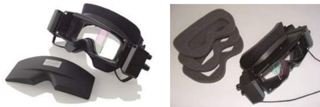
Рис. 2.6-2: Маска с боковыми камерами со съемной крышкой (слева) и съемными одноразовыми пенопластовыми прокладками (справа)
