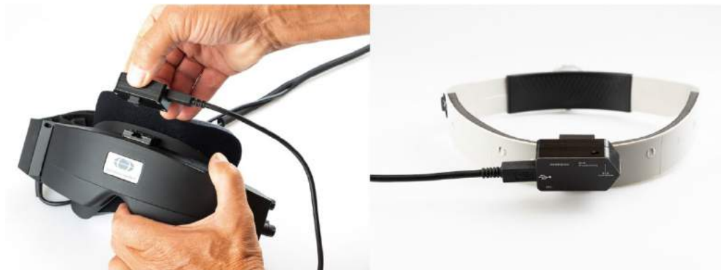
Рис. 2.6-17: Крепление VORTEQ™ 2 е поколение IMU на маске с боковыми камерами (слева) и изображение прикрепленного на оголовье датчика для теста Динамической остроты зрения (справа)
