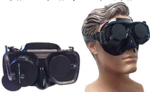
Рис. 2.6-6: Стандартная маска с верхними камерами (слева) и маска с передней камерой малого размера (справа)
