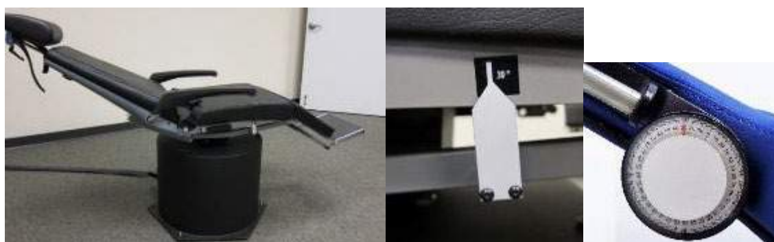
Рис. 3.9-3 Откидное кресло для калорического теста с маркером угла ирригации и шкалой наклона
