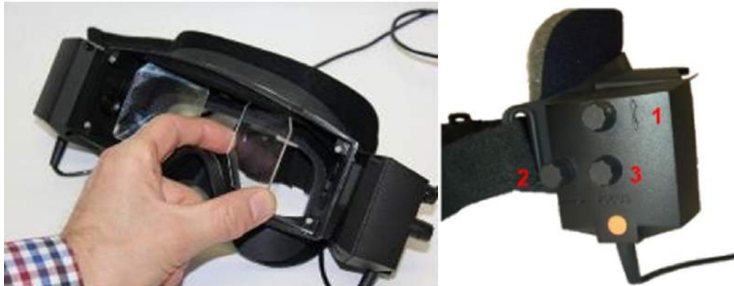
Рис. 2.6-4: Регулируемые ИК зеркала для настройки межзрачкового расстояния (слева) и ручки для 1) вертикального регулирования камеры, 2) горизонтального регулирования камеры, 3) фокусировки камеры (справа)
