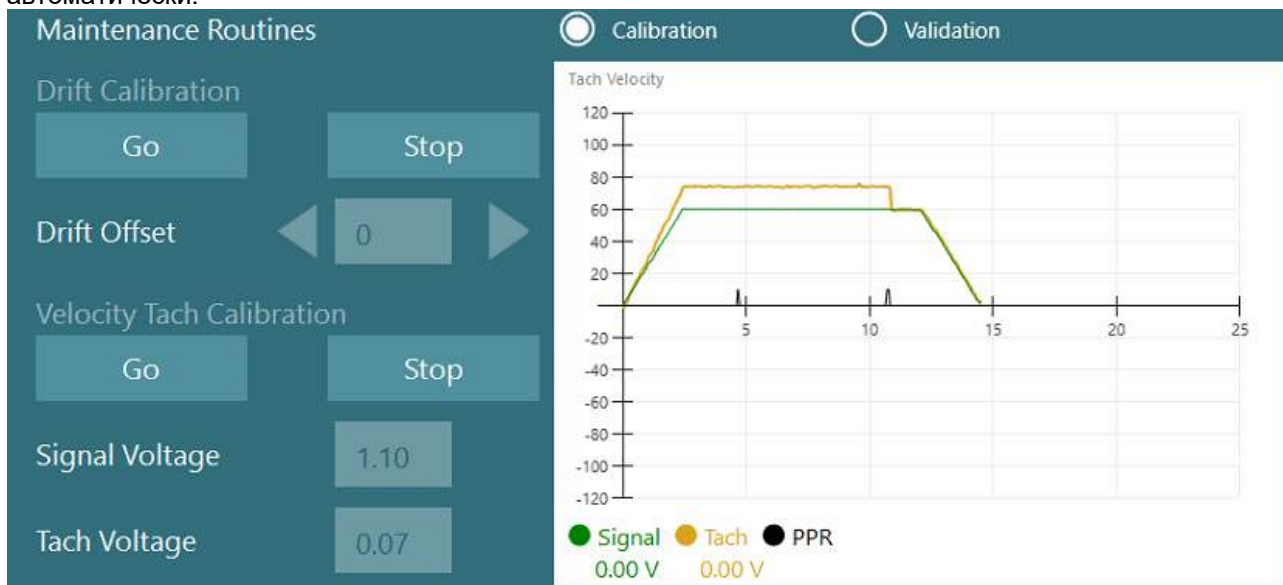
Рис. 2.6-37: Калибровка дрейфа и тахометра скорости для оптокинетического барабана для кресел Авто-Траверс/Комплексное
