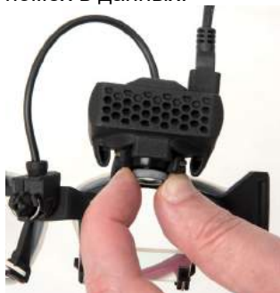
Рис. 2.6-8: Фокусировка изображения на маске EyeSeeCam
