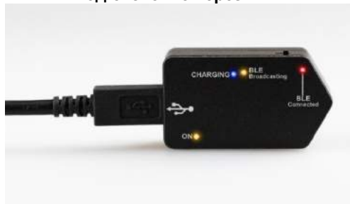
Рис. 2.6-18: VORTEQ™ 2 е поколение IMU с включенными светодиодами
