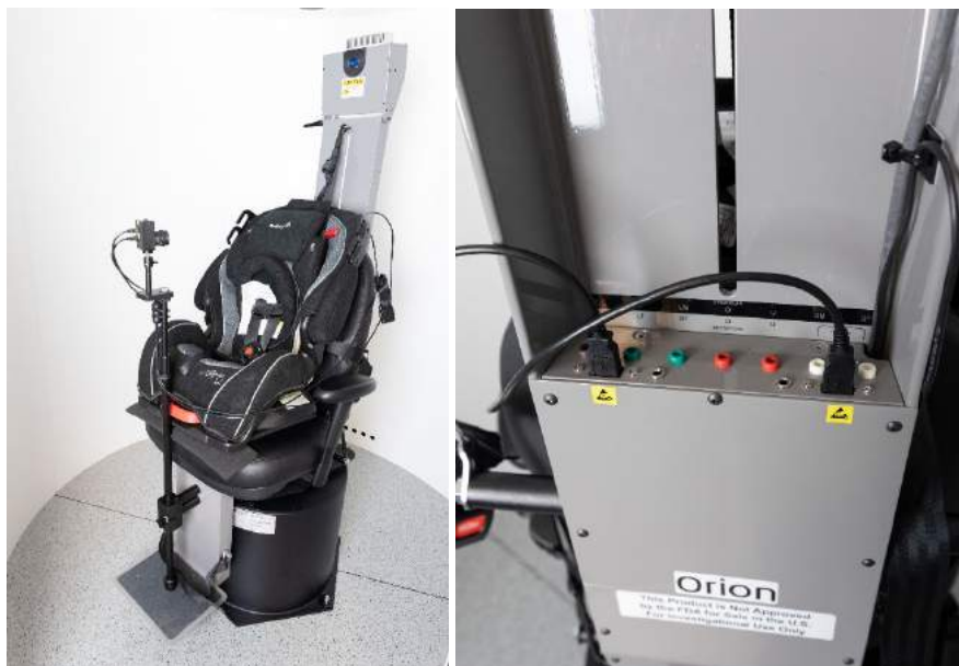
Рис. 2.6-30: Педиатрическая камера наблюдения, прикреплена к креслу Orion Авто-Траверс/Комплексное и подключена к USB-портам на спинке кресла
