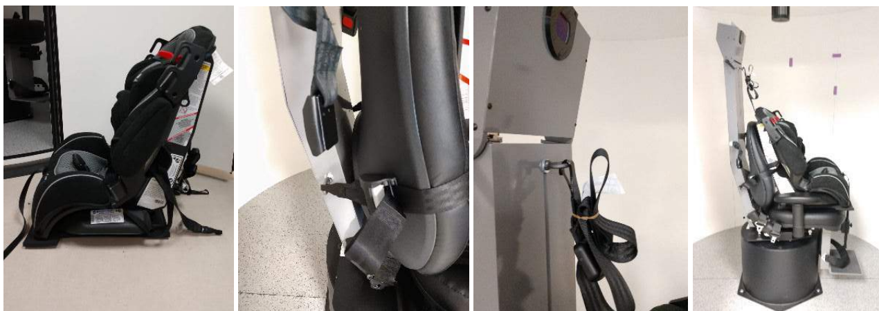
Рис. 2.6-29: Последовательность установки детского автокресла на кресле Авто-Траверс/Комплексное (слева направо)
