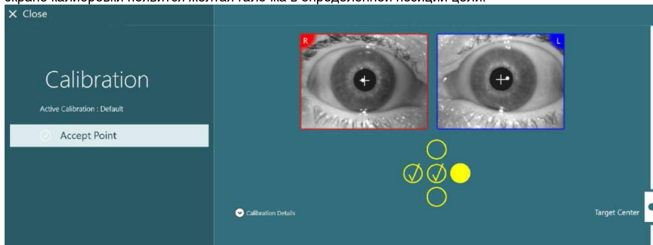
Рис. 3.7-2: Экран калибровки во время стандартной процедуры калибровки. На принятых позициях цели появляется желтая галочка
