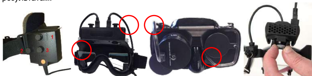
Рис. 3.6-2: Регулировка фокуса на различных масках VNG и vHIT
