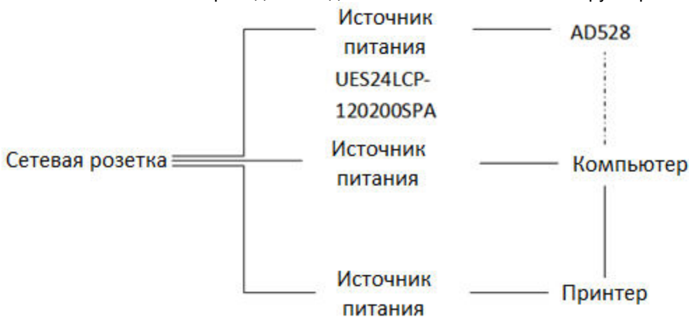
Рис. 2. Использование проводного подключения AD528 к компьютеру и принтеру.
