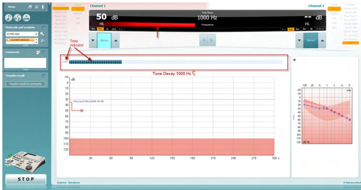
4. Если пациент перестал слышать тон (отпустил кнопку) до истечения 1 минуты, интенсивность тона повышается на 5 дБ, а отсчет времени (в верхней части экрана) начинается заново.
