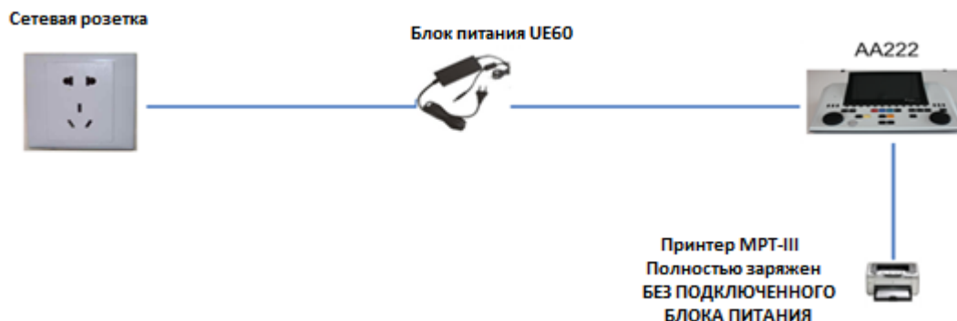
Рис. 4. Использование AA222 совместно с прошедшим медицинскую аттестацию блоком питания UES65-240250SPA3 и принтером MPT-III.
