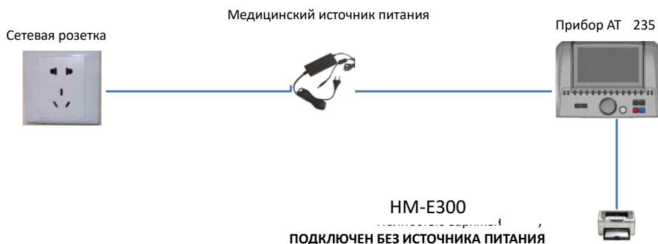
Рис. 3. AT235 используется с одобренным для медицинского применения блоком электропитания UES65-240250SPA3, а для печати используется принтер НМ-Е300/МРТ-III.
