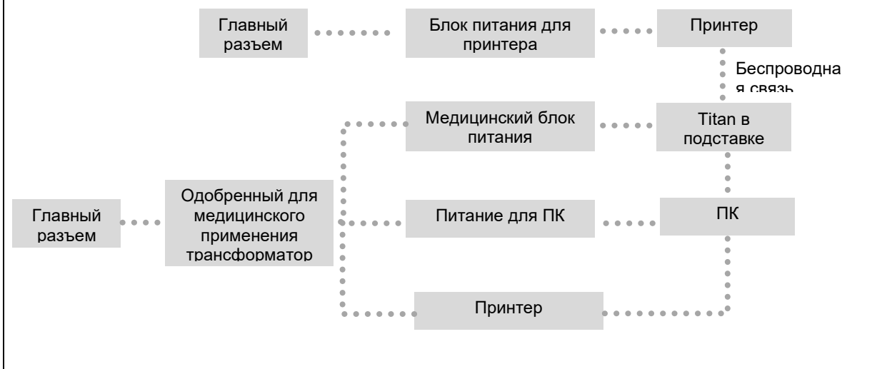
Рис. 7. Использование Titan с подставкой, с одобренным для медицинского применения блоком электропитания, с оптическим USB подключением к ПК и беспроводным подключением к принтеру. Подходящая конфигурация для использования с ABRIS440 — обеспечивается безопасность пациента.
