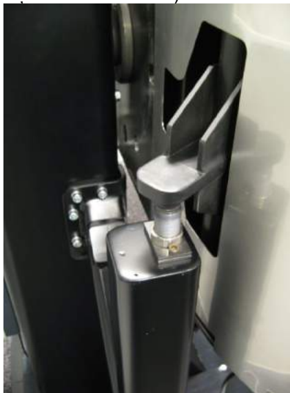
Oprirea va activa amortizorul hidraulic superior în timpul canalului orizontal DPRM.
