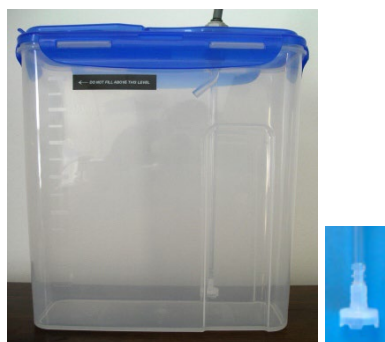
Figura 4 Reservatório externo com filtro coletor
