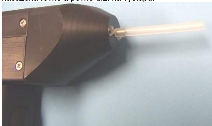
Obrázek6 Lehce zatáhněte za silikonovou koncovku a ujistěte se, že je připevněna.
