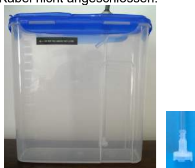
Abbildung 4 Externer Behälter mit Aufnahmefilter
