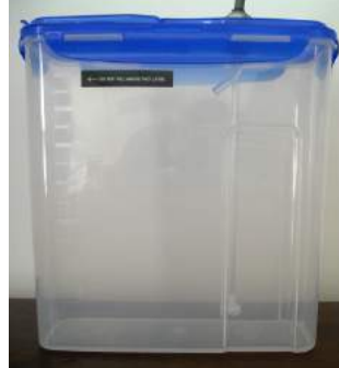
Εικόνα 4 Εξωτερική δεξαμενή με φίλτρο συλλέκτη
