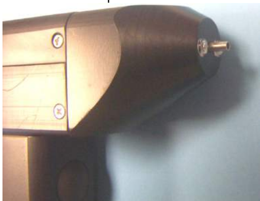
Figura 5 Colocar la punta de silicona en el mango de irrigación.
