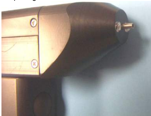
Abbildung 5 Setzen Sie die Silikonspitze auf den Handapparat auf.
