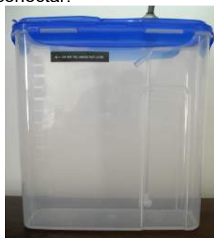
Figura 4 Depósito externo con filtro de recogida
