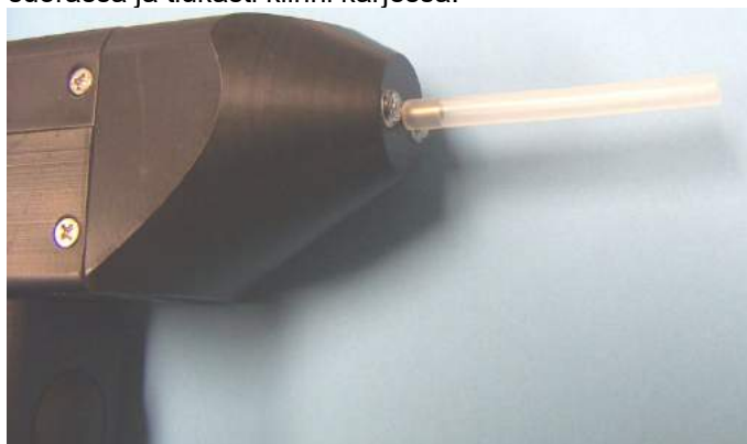
Kuva 6 Vedä silikonikärkeä kevyesti ja varmista, että se on tukevasti kiinni.
