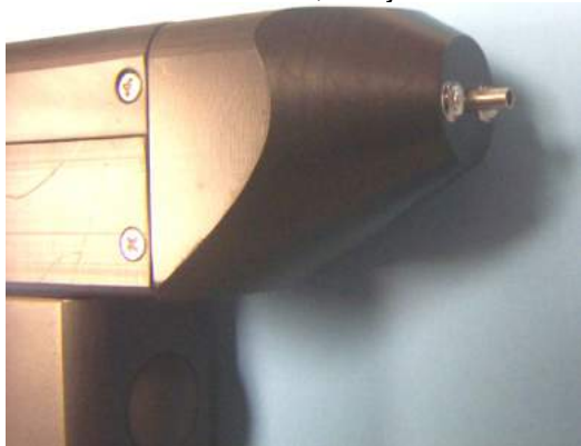
Obrázek5 Umístěte silikonovou koncovku na irigační rukojeť.
