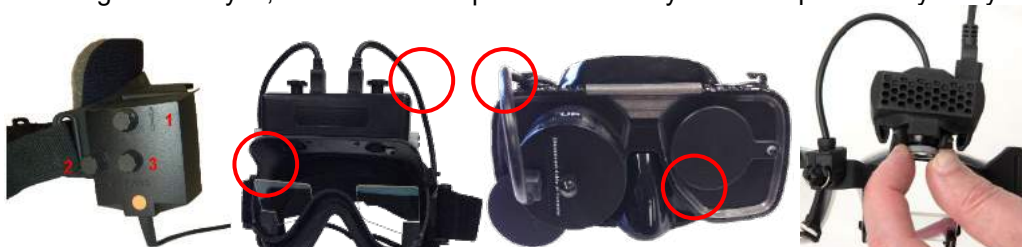
Rysunek 3.6-2: Regulacja ostrości w różnych goglach VNG i vHIT
