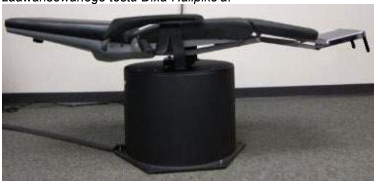
Rysunek 3.9-1 Pełne rozłożenie fotela do badania Dix-Hallpike'a z wymontowanym zagłówkiem (Orion i System 2000)
