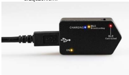
Rysunek 2.6-18: Inercyjny zespół pomiarowy VORTEQ™ 2. generacji z włączonymi diodami LED
