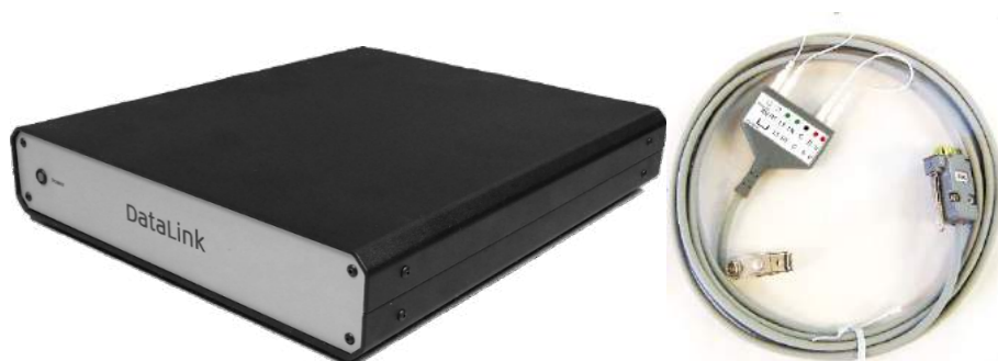
Rysunek 2.6-38: Urządzenie DataLink i przewód pacjenta do badania EOG
