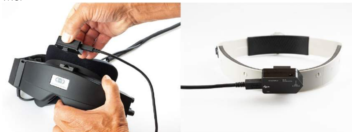
Rysunek 2.6-17: Inercyjny zespół pomiarowy VORTEQ™ 2. generacji zamontowany w goglach z boczny mocowaniem (po lewej) i zamontowany na opasce na głowę do testu dynamicznej ostrości widzenia (po prawej)
