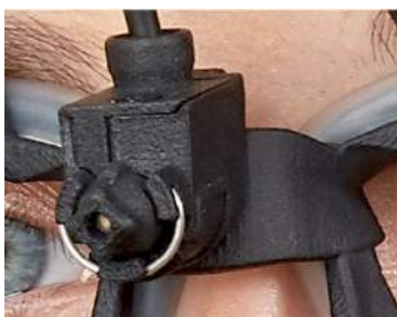
Rysunek 2.6-9: Laser kalibracyjny w goglach EyeSeeCam.
