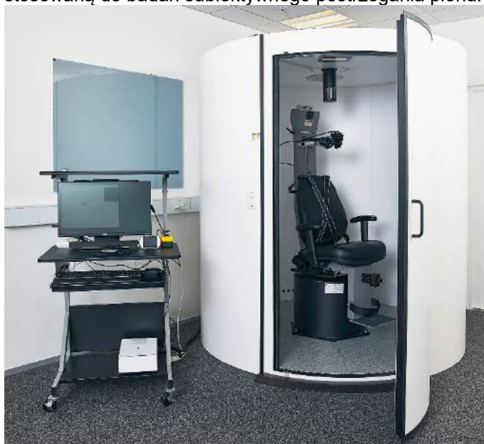
Rysunek 2.6-24: Fotel obrotowy Orion Auto-Traverse/Comprehensive
