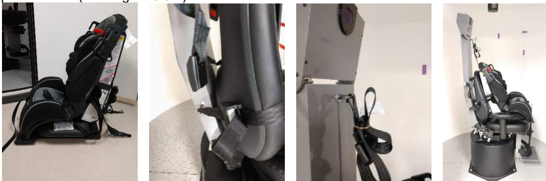
Rysunek 3.5-4 Ilustracje przedstawiające kolejne etapy procedury mocowania fotelika dziecięcego na fotelu AT/C (od lewej do prawej)
