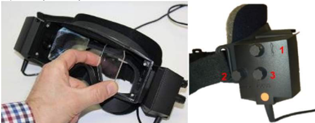
Rysunek 2.6-4: Regulowane lustra IR umożliwiające regulację rozstawu źrenic (po lewej) oraz pokrętki do 1) regulacji kamery w pionie, 2) regulacji kamery w poziomie, 3) regulacji ostrości obrazu (po prawej)
