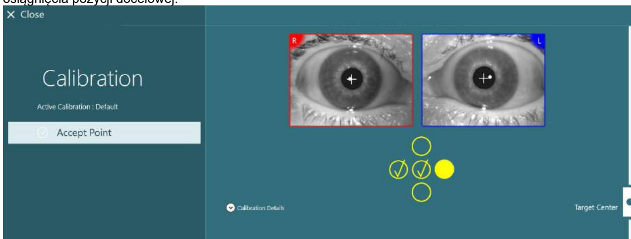
Rysunek 3.7-2: Ekran kalibracji podczas standardowej procedury kalibracji. Przy zaakceptowanych pozycjach celu pojawia się żółty znak kontrolny
