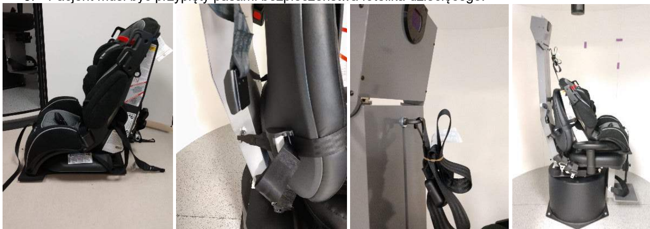
Rysunek 2.6-29: Ilustracje przedstawiające kolejne etapy procedury mocowania fotelika dziecięcego na fotelu z funkcją automatycznego przesunięcia (Auto Traverse) i do badań kompleksowych (Comprehensive) (od lewej do prawej)
