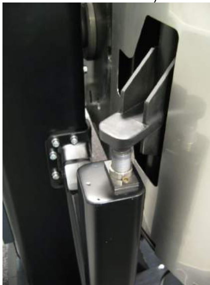
Ogranicznik wchodzi w kontakt z górnym amortyzatorem hydraulicznym podczas manewrów DPRM kanału poziomego.
