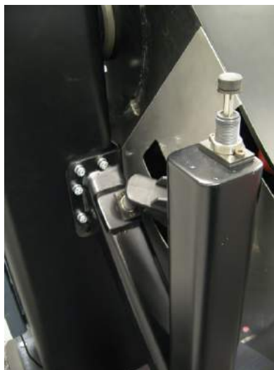
Ogranicznik wchodzi w kontakt z dolnym amortyzatorem hydraulicznym podczas manewrów DPRM kanału pionowego.
