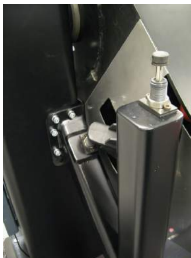
Stoppet vil gå i inngrep med den nedre, hydrauliske støtdemperen ved DPRM for vertikale bueganger.
