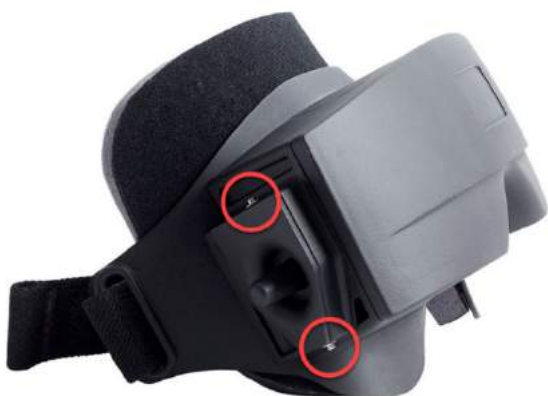
Afbeelding 2.6-3: Zeskantbevestigingsschroeven aan de boven- en onderkant van de bril met zijbevestiging, gebruikt voor bevestiging van een camera of kap (zie afbeelding)
