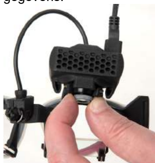
Afbeelding 2.6-8: Scherpstelling op de EyeSeeCam-bril
