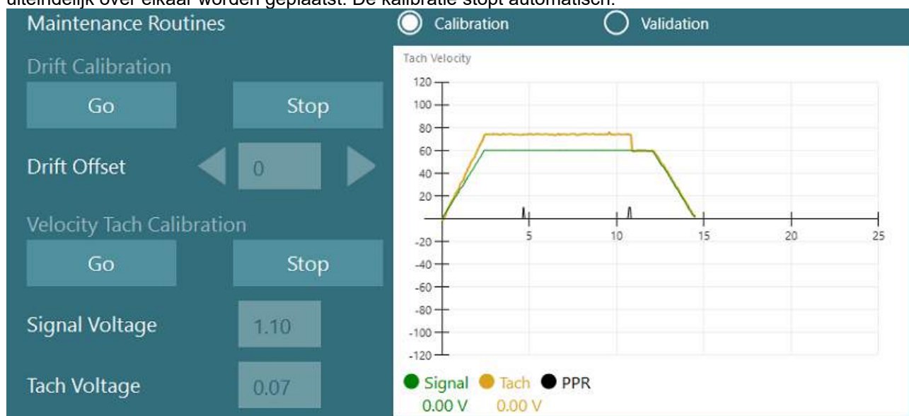
Afbeelding 2.6-37: Drift- en snelheidstachykalibratie voor de optokinetische drum op de Auto-Traverser/Comprehensive stoel
