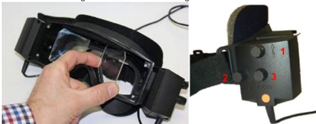
Afbeelding 2.6-4: Verstelbare IR-spiegels voor oogafstandsinstelling (links) en knoppen voor 1) verticale camera-instelling, 2) horizontale camera-instelling, 3) camerafocusinstelling (rechts)
