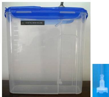
Afbeelding 4 Externe tank met opvangfilter
