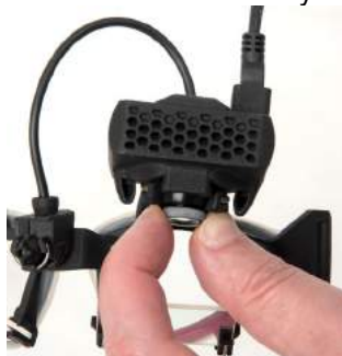
Pav. 2.6-8: Fokusavimo reguliavimas ant „EyeSeeCam“ akinių
