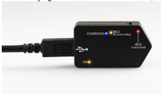
Pav. 2.6-18: VORTEQ™ 2 kartos IMU su įjungtais šviesos diodais
