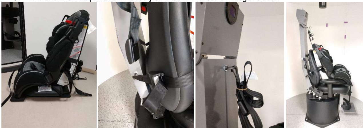
Pav. 2.6-29: Vaikiškos kėdutės pritvirtinimas ant AT / C krėslo – iš eilės pateikti vaizdai (iš kairės į dešinę)
