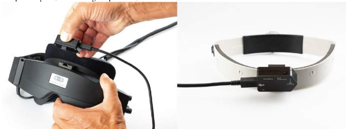
Pav. 2.6-17: Antrosios kartos VORTEQ™ IMU yra tvirtinamas ant šoninio tvirtinimo akinių (kairėje) ir tvirtinamas ant galvos juostos, kad būtų galima atlikti „Dynamic Visual Acuity“ tyrimą (dešinėje).
