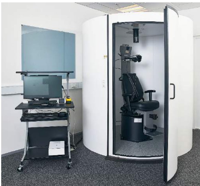
Pav. 2.6-24: „Orion“ šoninio poslinkio / įvairiakryptės rotacinės kėdės
