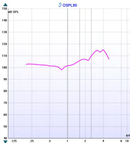
グラフは、測定された HIT カーブを表示します。X 軸は周波数を示し、Y 軸は実行した測定に応じて出力または利得を示します。
