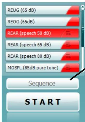
**Current Protocol**（プロトコルの測定項目）は、左下にリスト表示されています。現在実施している測定とバッテリー内の他の測定が強調表示されます。チェックマークは、測定が実施されたことを示します。プロトコルは、「REM440 設定」で作成および調整できます。各測定項目の **Color**（色）は、プロトコルで設定された各測定の色で表示されます。
