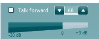
「トークオーバー」では、トークオーバー用マイクを有効にします。矢印ボタンを使用して、現在使用中のトランスデューサーを介したトークオーバー時の呈示レベルを設定できます。VU メーターが 0 dB を示す位置が、正確なレベルとなります。
