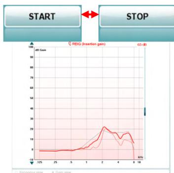
「**開始/停止**」ボタンは、現在の測定を開始および停止します。「開始」を押すと、ボタンが「停止」に変わります。
