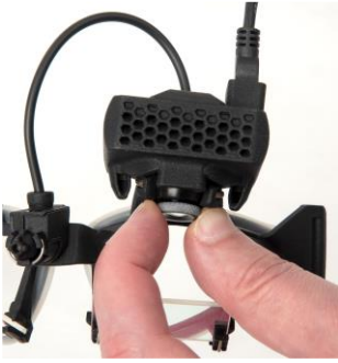
図 2.6-6: EyeSeeCam ゴーグルのピント調整
