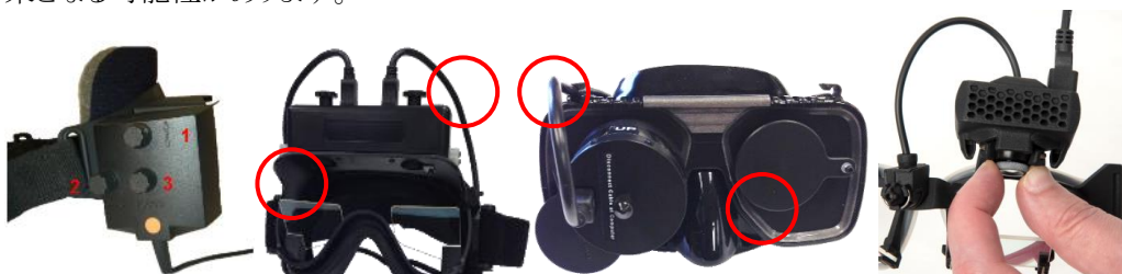
図 3.6-2: VNG 用/vHIT 用ゴーグルのピント調整
