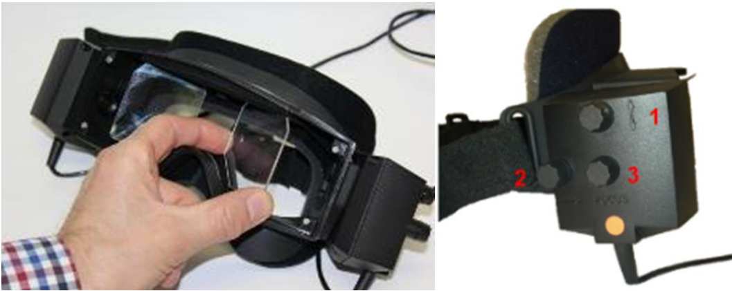
図 2.6-4: 左:瞳孔間距離の調整が可能な IR ミラー
